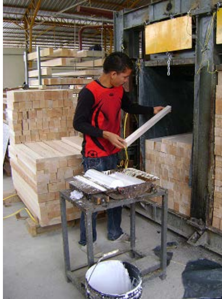
Figura No.6 “Encolado de la Madera”
