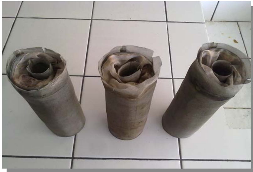
Fotografía (2,4): Filtros de malla metálica, adentro los forros de organza.
