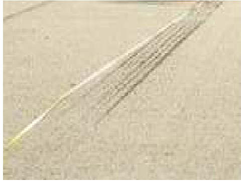
Fotografía 3.15 Marcas de aceleración.
