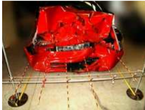
Fotografía 3.13 Medición de la deformación residual.
