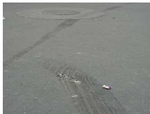
Fotografía 3.17 Marcas combinadas frenada-derrape.
