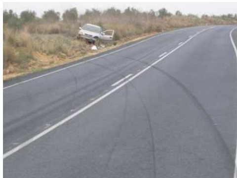
Fotografía 3.16 Marcas de derrape.
