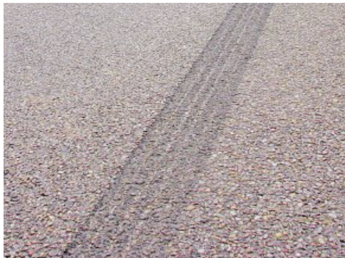
Fotografía 3.14 Marcas de frenada.
