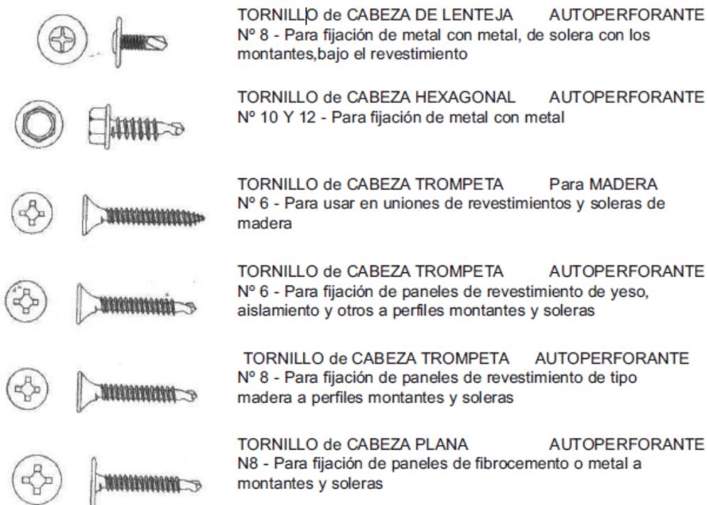
Figura 2.34. Tipos de Tornillos: Fuente [9]
