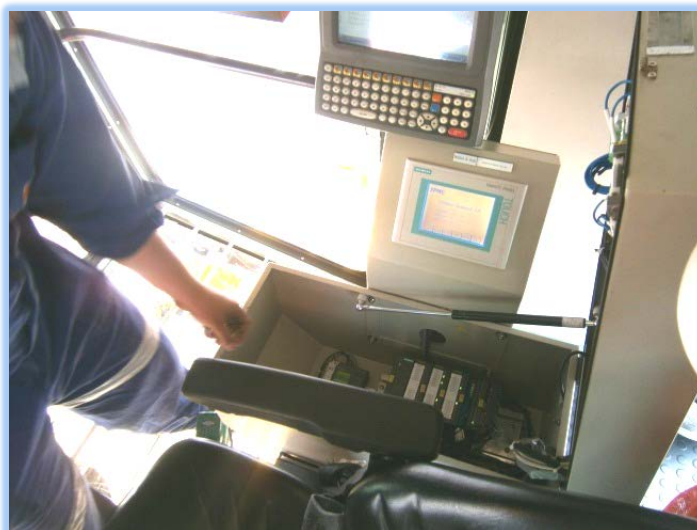
Foto 4.11: Revisión de la Instalación del LOGO
