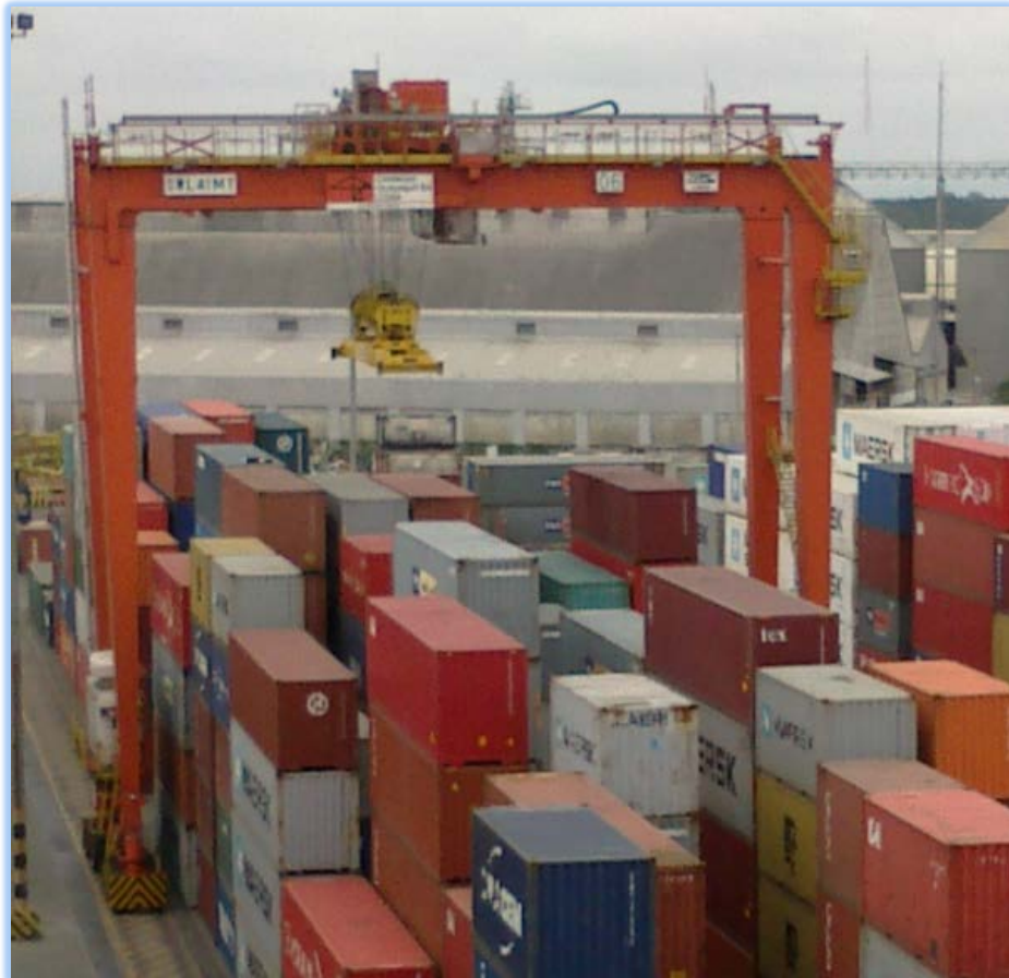
Foto 2.1: Vista Panorámica de la Grúa Pórtico Rubber Tyred Gantry
