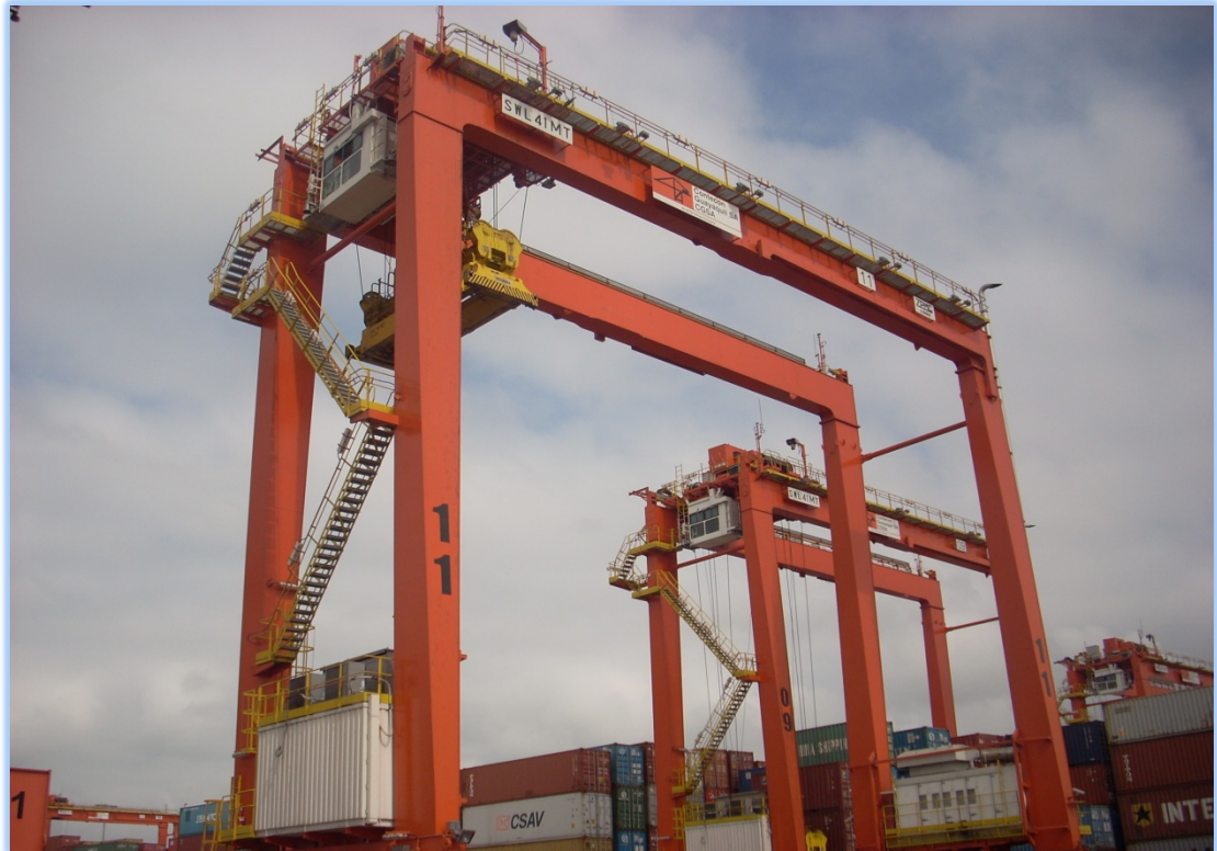
Foto 1.1:Imagen Panorámica de la Grúa Pórtico Rubber Tyred Gantry
