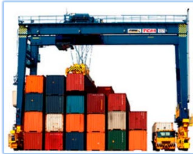
Figura 1.1:Apilamiento desde 4 hasta 6 alturas de contenedor
