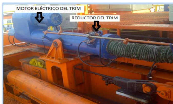
Foto 2.17: Imagen del Reductor del Trim de la Grúa.
