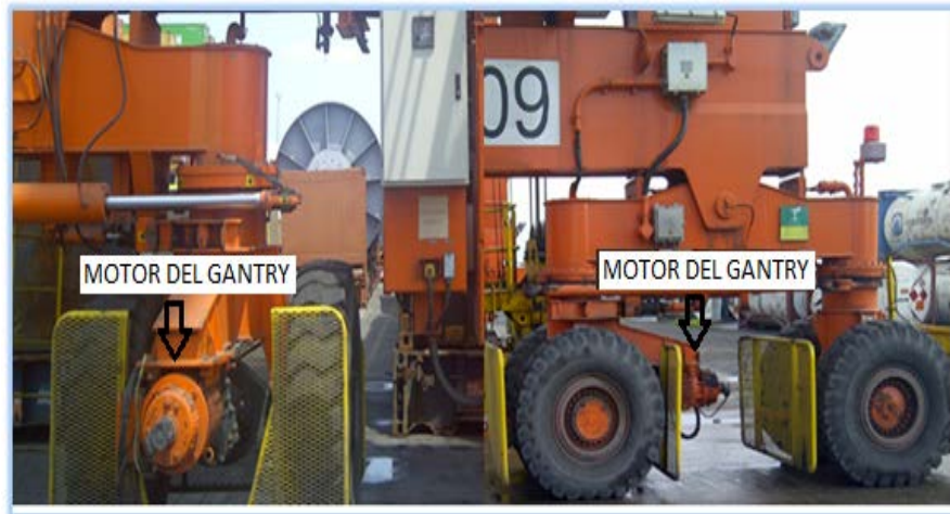
Foto 2.9: Vista del Motor del Sistema Gantry
