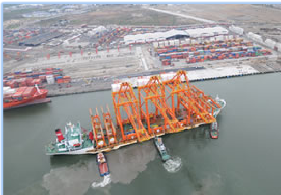
Figura3.1:Máquinas RTG llegando al Puerto de Guayaquil
