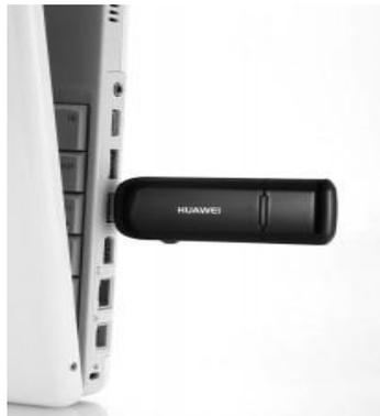
**Gráfico # 12. Modem USB para conexiones de telefonía móvil (3G y GPRS)**
