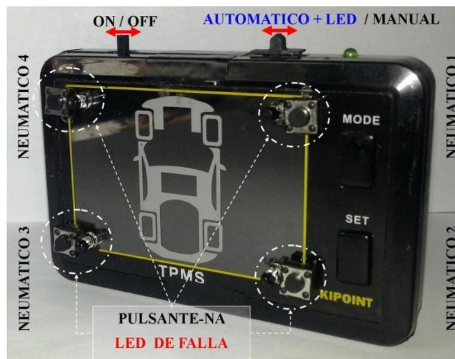
**Fig. 2.29** Vista frontal del Monitor, detalle de funciones de elementos de mando
