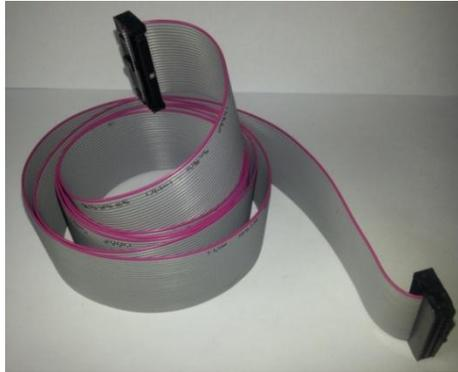
**Fig. 2.34** Bus de datos de 26 vías, con conectores machos IDC
