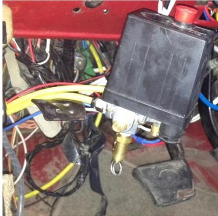
**Fig. 3.1** Presostato, válvula de seguridad, pulsante de apagado
