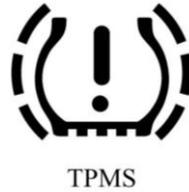
**Fig. 1.13** Señal ISO, indica mal funcionamiento del sistema TPMS
