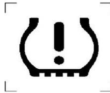
**Fig. 1.11** Señal ISO, indica, baja presión en un neumático
