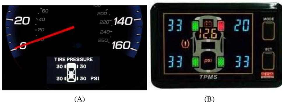
**Fig. 1.20** Pantallas gráficas de visualización, (A) Panel de instrumentos (B) Receptor específico.
