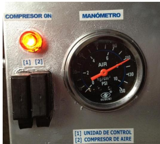
**Fig. 4.4** Compresor activado, carga de aire.
