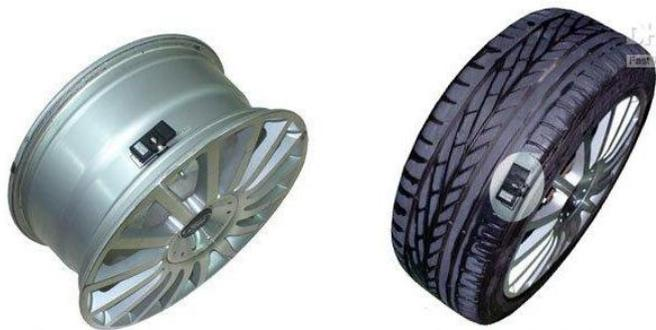
**Fig. 1.18** Sensor TPMS instalado en el neumático
