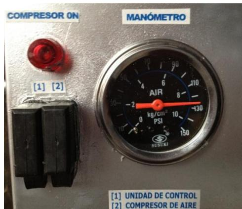
**Fig. 3.1** Manómetro, indica la presión de aire en el depósito
