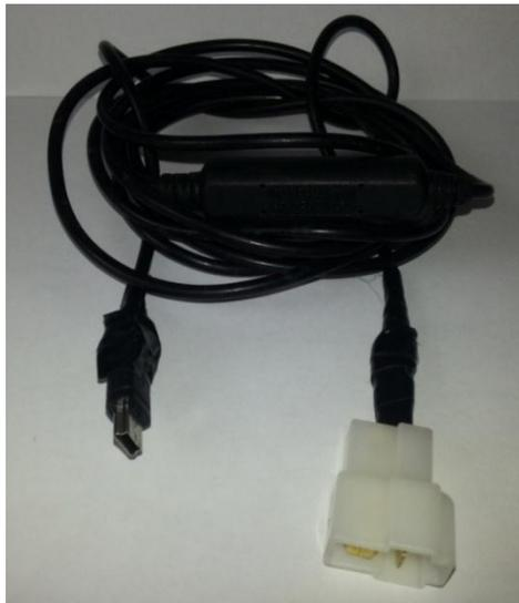
**Fig. 2.35** Cable alimentación del monitor TPMS
