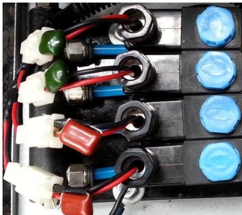
**Fig. 4.5** Instalación de los condensadores cerámicos
