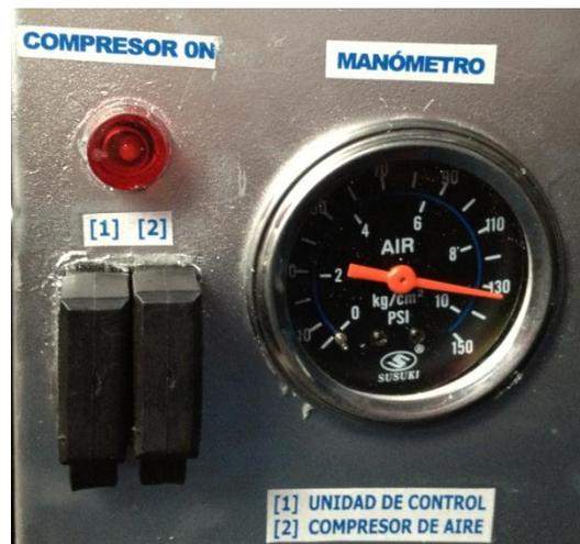
**Fig. 4.3** Manómetro, presión de Aire en el sistema neumático
