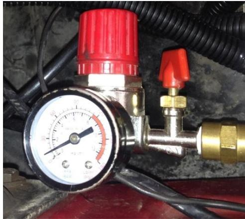
**Fig. 3.1** Regulador de presión de aire.
