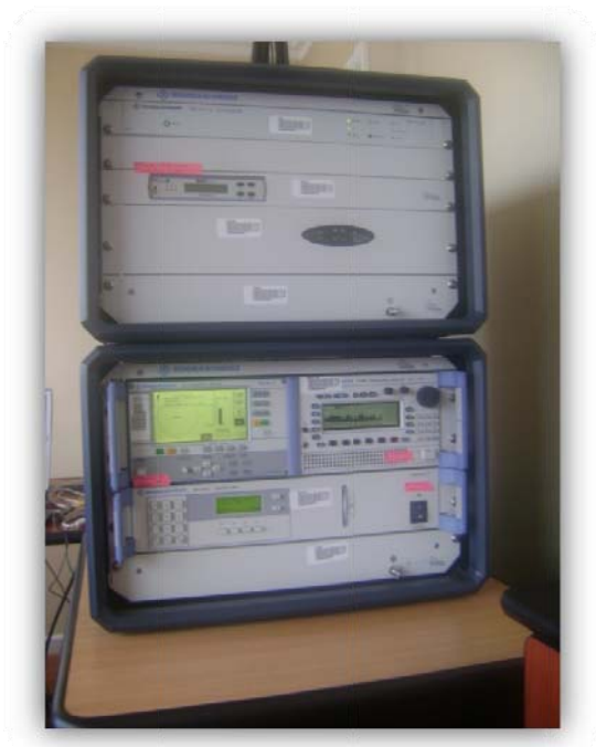
Figura A1.8 Vista frontal de la unidad de medición R&S ARGUS-IT.
