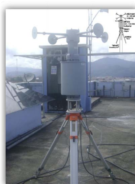
Figura A1.3 Antenas HE314A1H (20MHz-500MHz) y HF214H (500MHz-1300MHz).
