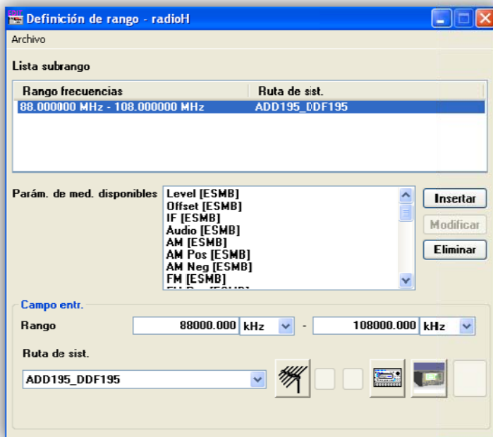
Figura 4.16. Interfaz de configuración del rango de frecuencias del MMA.
