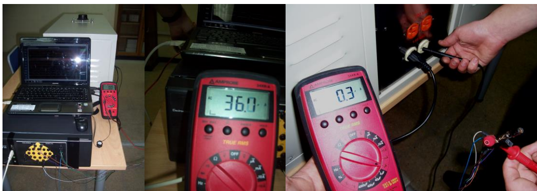
Figura 4.3: Mediciones para la prueba de corriente de fuga.
