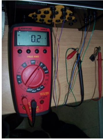
Figura 4.5: Medición para la prueba de corriente auxiliar de paciente.
