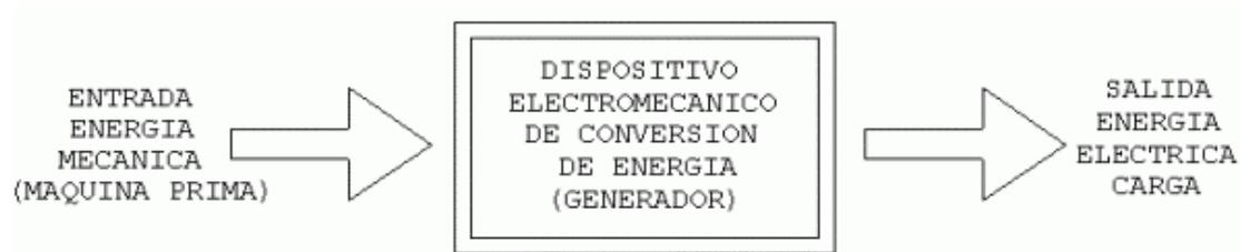
*Figura 1.6 Generador de Corriente Alterna. [6]*
