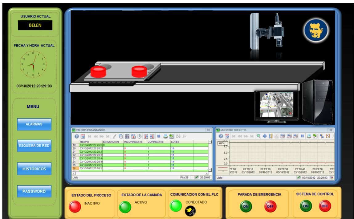
Figura 3-69. Entorno de la Imagen Inicio del Sistema SCADA
