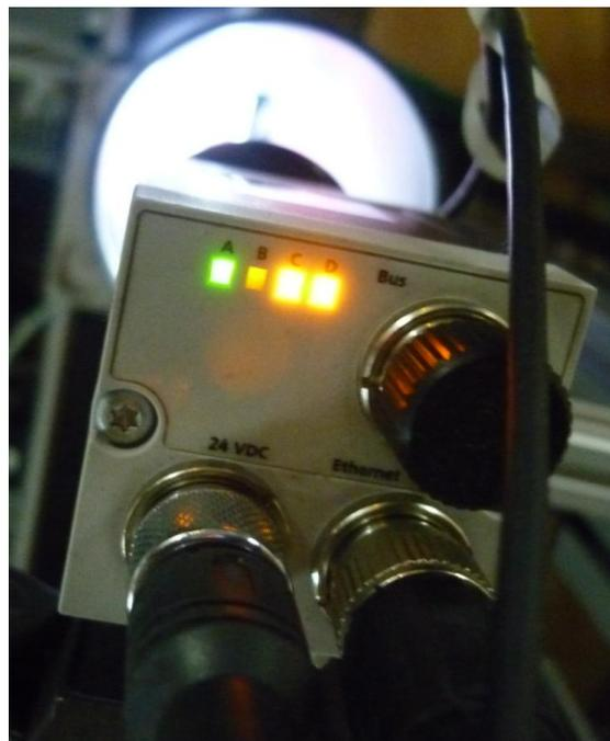
**Figura 4-8. Estado de conexión de la cámara hacia la red Ethernet.**
