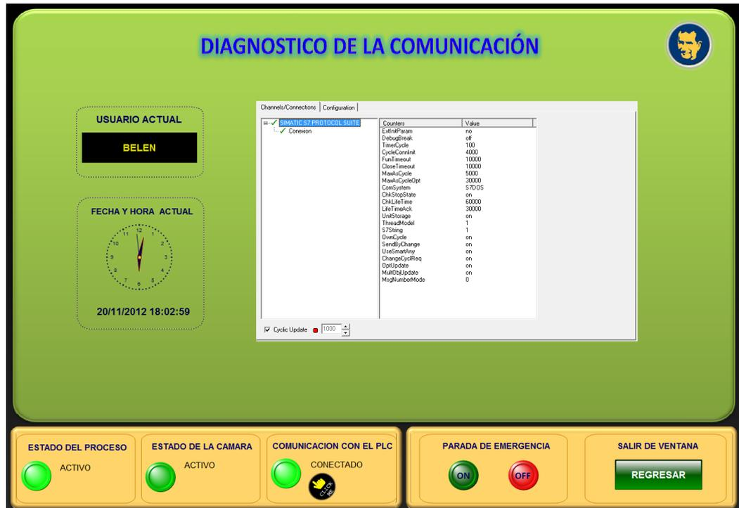
Figura 4-12. Estado de Conexión entre WinCC Explorer y el PLC S7-300
