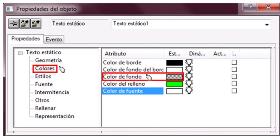
Figura A.3-35 Configuración del Fondo del Objeto
