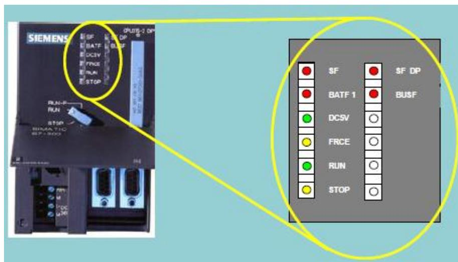
Figura 3-7. Leds indicadores de estado del PLC S7-300
