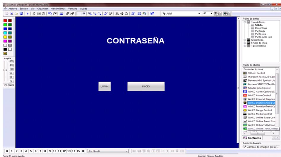
**Figura A.3-46 Diseño de la Pantalla Principal del Scada**
