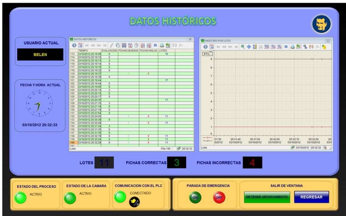
Figura 3-72. Entorno de la Imagen datos Históricos del Sistema SCADA.
