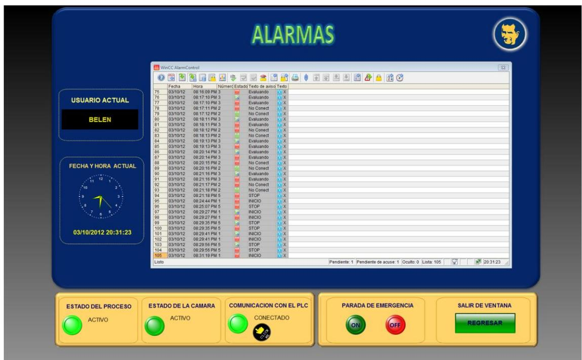
Figura 3-70. Entorno de la Imagen Alarmas del Sistema SCADA
