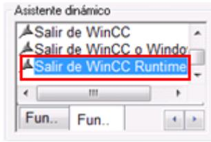
**Figura A.3-49 Asistente Dinámico para salir del Runtime**
