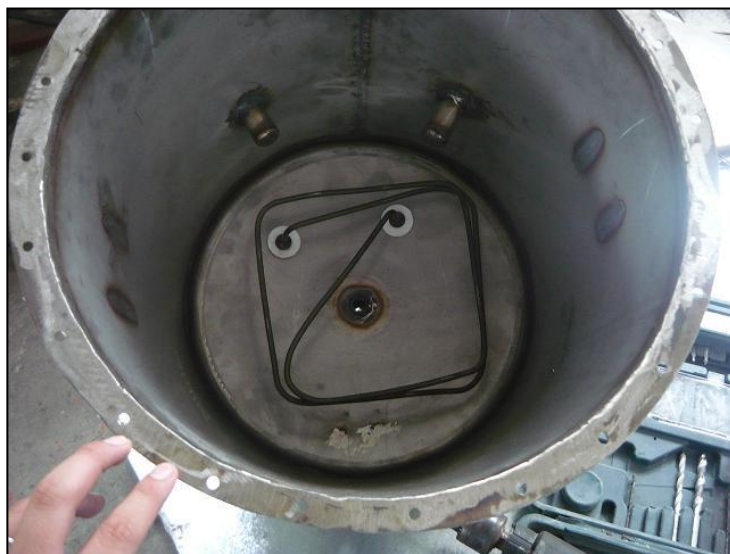
Figura 3.1: Instalación de Resistencia Calentadora y Empaque al interior del Tanque Reactor
