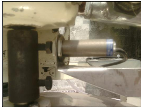
Figura 3.7: Montaje del Sensor Inductivo para la lectura RPM
