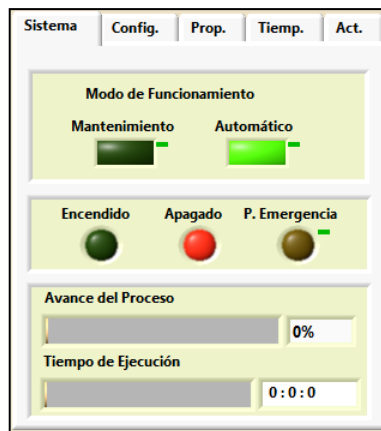
Figura 4.2: Pantalla Opción “Sistema” del control SCADA Fuente: Autores
