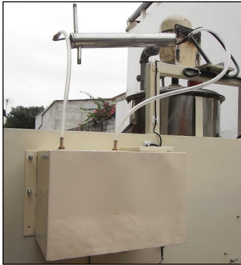
Figura 3.8: Deposito de Agua y Condensador Fuente: Autores
