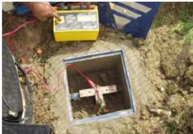
Figura 3-3 Medición de la RPT de los diferentes SPT construidos en el CTIG
