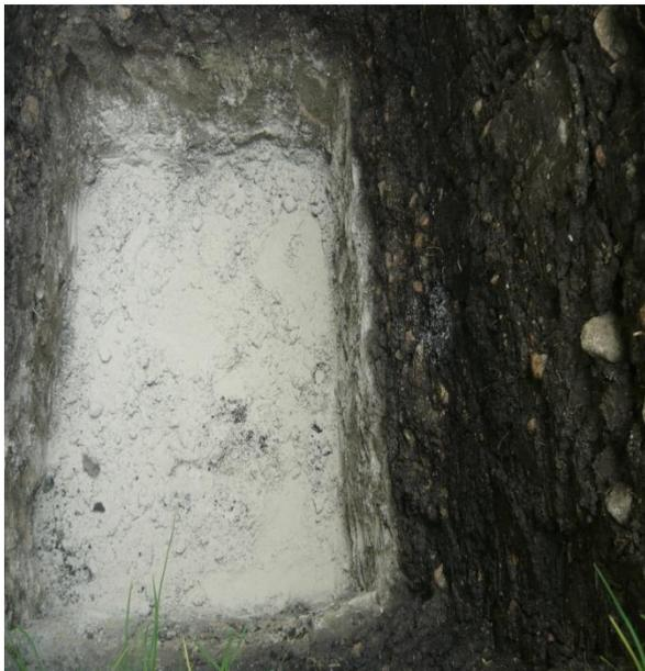
Foto 3-12 Adición de la dosis de gel correspondiente al SPT3
