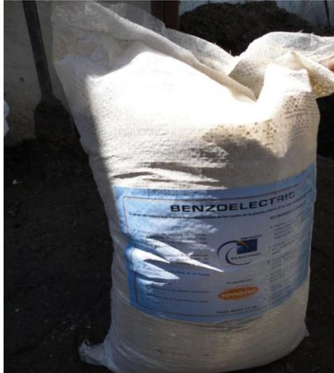
Foto 3-1 Gel Benzolectric utilizado en el CTIG para elaborar los SPT
