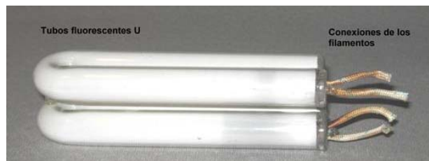
Fig. 1.1.4 Tubo fluorescente en forma de u invertida.
