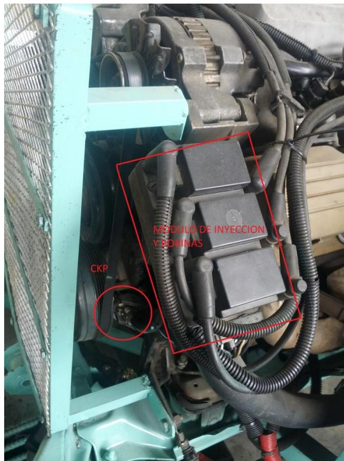
Fig. 18 Ubicación real del CKP y Modulo de inyección. Fuente: el autor.
