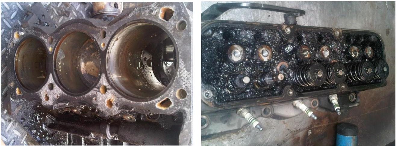
Fig. 17. Estado del bloque motor y del cabezote, examinados durante el desarmado. Fuente: el Autor.
