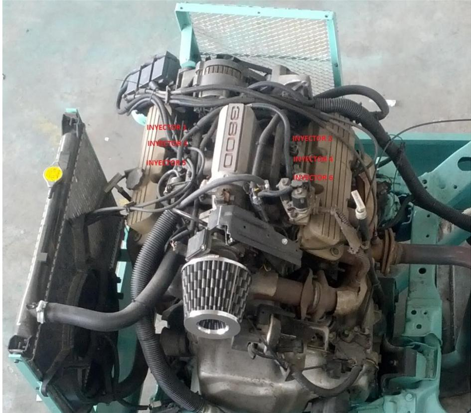
Fig. 19. Ubicación de inyectores. Fuente: el autor.
