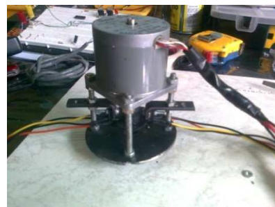
fig. 52 Imágenes de los opto acopladores y su acople en el motor de pasos.
