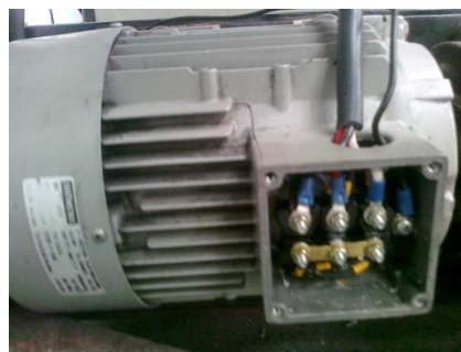
Fig. 83 Conexión de los cables del motor eléctrico desde el variador de frecuencia.
