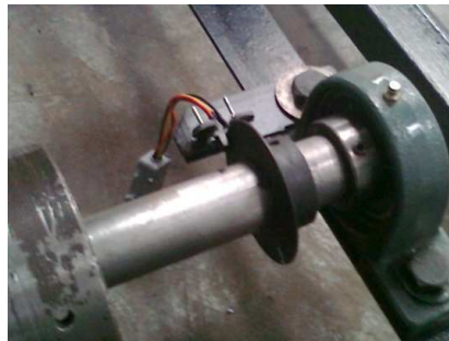
Fig. 65 Imagen del montaje del opto acoplador en el banco de pruebas.
