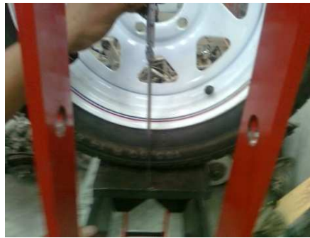
Fig. 36 Medición de la altura de la cámara del neumático.
