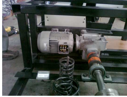
Fig. 3 Montaje del eje en donde se encuentra la rueda excéntrica.
