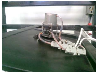
Fig. 6 Colocación del motor de pasos
