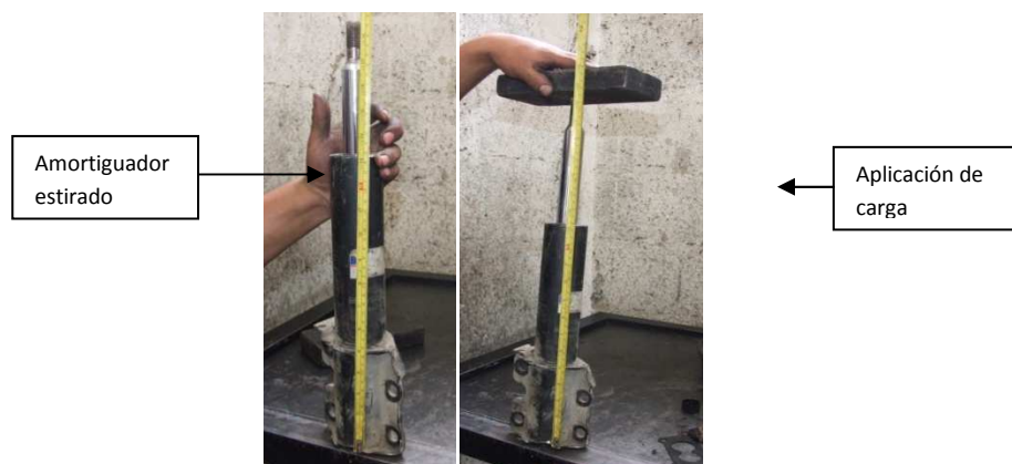
Fig. 14 Método de obtención del coeficiente R de amortiguamiento.
