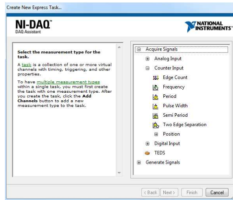
Fig. 61 Configuración del puerto de conteo de pulsos.
