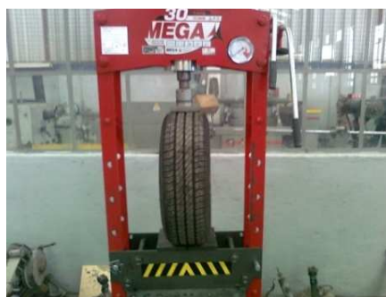
Fig. 35 Cálculo de la constante de rigidez del neumático.
