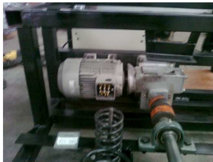
Fig. 71 Imagen del montaje del motor eléctrico, reductor, acople tipo araña y las chumaceras con el eje.
