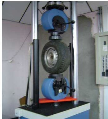
Fig. 33 Caracterización del neumático en un banco de pruebas universal. (Fuente de la imagen de la publicación de Ing. JUAN JOSÉ ARBELÁEZ T, Ing. JUAN PABLO MARÍN Q, MODELADO MULTICUERPO DE UN CUARTO DE VEHÍCULO LIVIANO)
