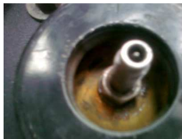
Fig. 7 Válvula de control para variar el coeficiente de amortiguamiento
