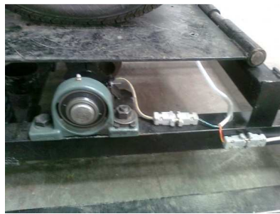
Fig. 7 Montaje del opto acoplador H21A1.
