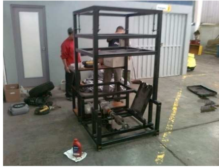
Fig. 73 Imagen del banco de pruebas finalizada la construcción y acoplados el resto de implementos.
