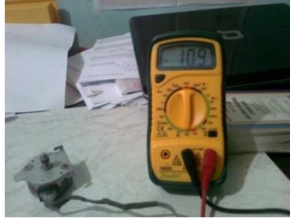
Fig. 46 Pruebas para encontrar el grupo de hilos.
