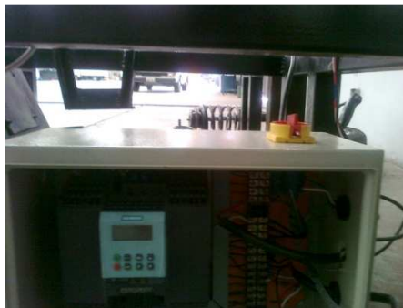
Fig. 2 Pruebas de funcionamiento del variador de frecuencia.
