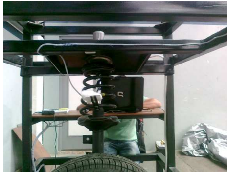
Fig. 8 Montaje de las bases para colocar el sensor y la superficie de referencia.
