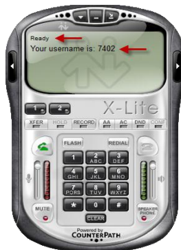
Fig. 4.42 Extensión registrada a la IP/PBX
