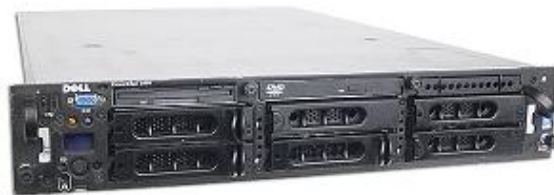
Fig. 2.2 Servidor Dell Power Edge 2850
