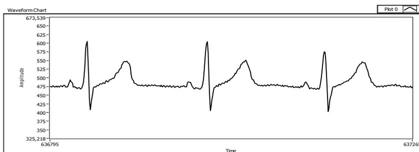
f.) Señal digitalizada derivación I usando Electrodo reusable tipo copa de succión de cloruro de plata, gel conductor, cable blindado para ECG y 30 muestras de promediación.
