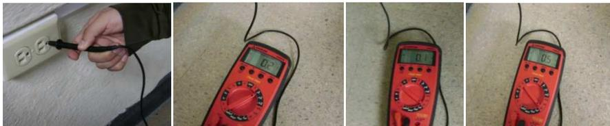
*Figura C.2.- Fotografía medición de corriente de fuga de paciente.*
