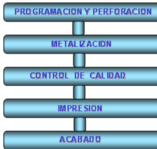
Figura 1.4.1.1. Diagrama de flujo del proceso de fabricación de circuitos impresos
