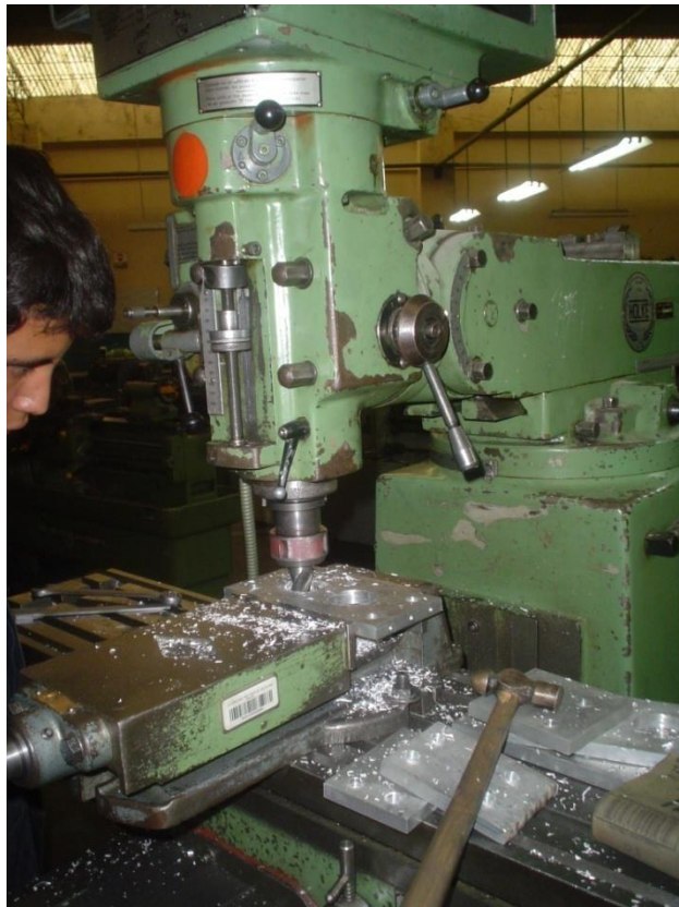
Figura 1.6.3.1 Taladrado y fresado de soportes
