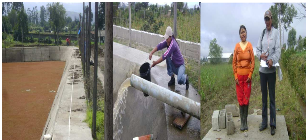
FOTOGRAFÍA 2. Medición de capacidad de almacenamiento de los reservorios, aforamiento de caudal de agua y georeferenciación, en la gestión integral del agua de riego en la comunidad de Cubinche, parroquia la Esperanza, cantón Pedro Moncayo 2011
