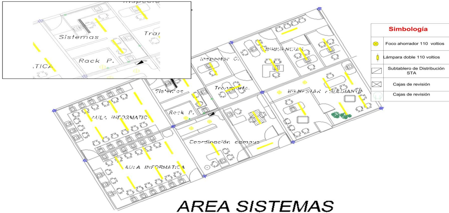
FIG.48. DIAGRAMA ILUMINACIÓN Y FUERZA DEPARTAMENTO DE SISTEMAS.
