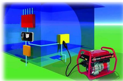
FIG. 1. TABLERO DE TRANSFERENCIA Y GRUPO ELECTRÓGENO 1
