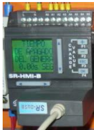
FIG. 58 PLC ARRAY CON INTERFAX HMI.
