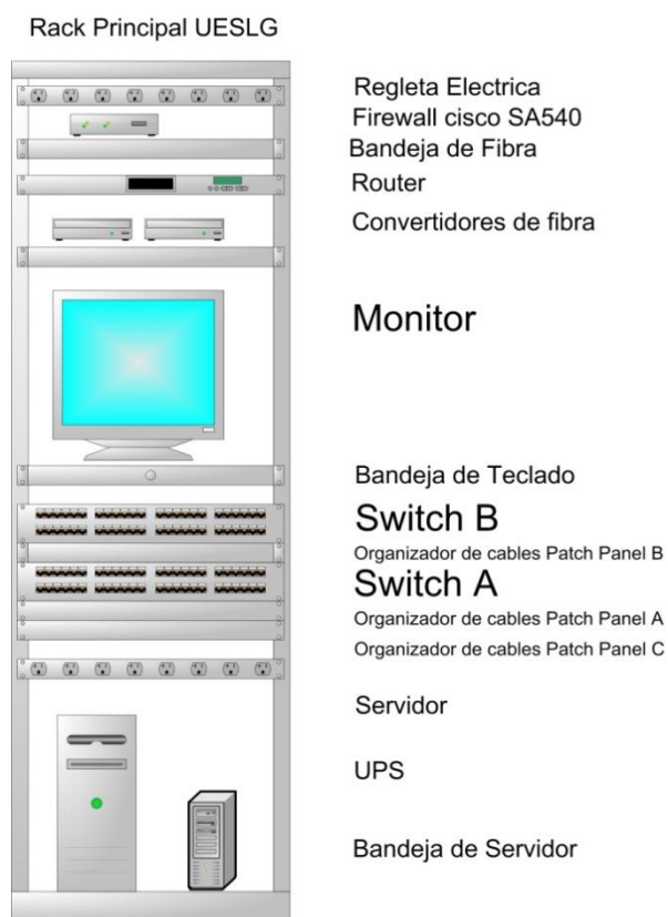
FIG.11. DESCRIPCIÓN RACK PRINCIPAL OFICINA SISTEMAS.
