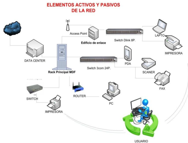
FIG. 5. ELEMENTOS ACTIVOS Y PASIVOS DE LA RED DE DATOS.
