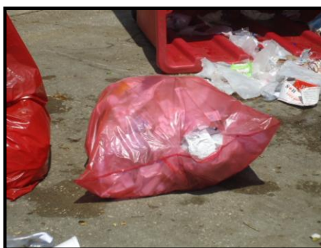
Figura N° 20. Fundas dañadas por exceso en su capacidad
