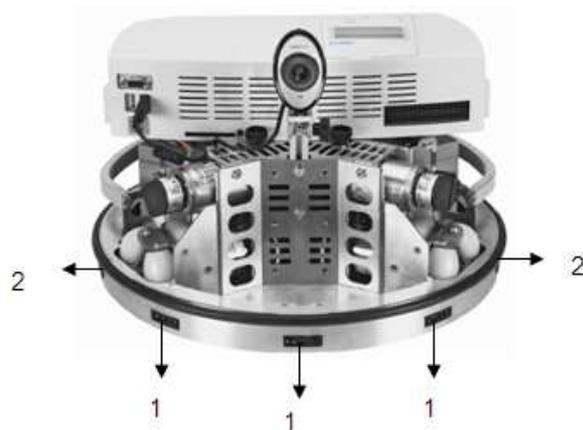
Figura 3.12 (1) Sensores de distancia, (2) Sensor anticollision.
