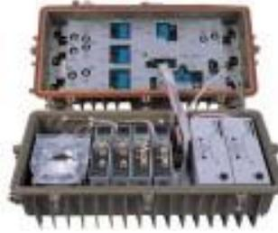
Figura 19 Nodo óptico KTR3224 para red troncal primaria
