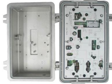
Figura 20 Amplificador mini bridger TBA/CX-TA-K
