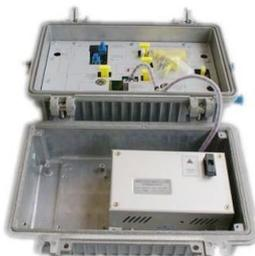
Figura 21 Amplificador SA822, utilizado en la red terciaria<sup>27</sup>
