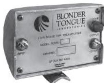
Figura 46 Preamplificadores CMA-b y SMCA Ub-single
