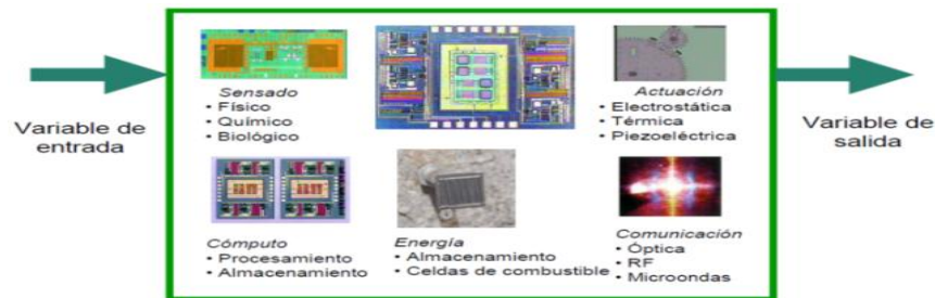
Cap.2: Fig. 13 Funcionamiento general de los MEMS.
