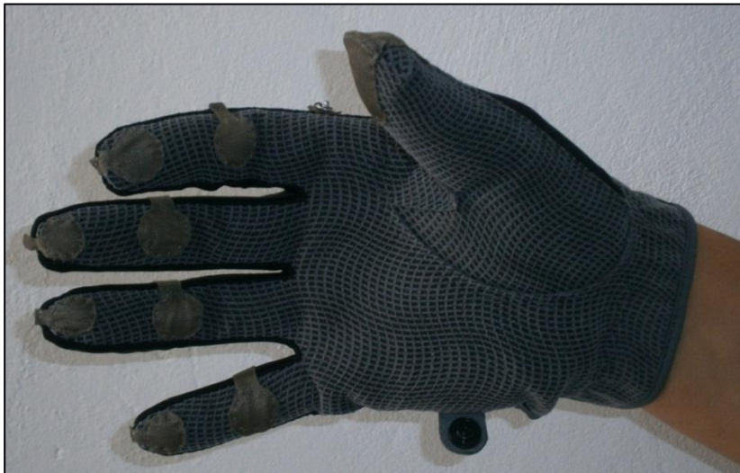
Cap.4: Fig. 27 Cara palmar “Guante Electrónico de Datos”.
