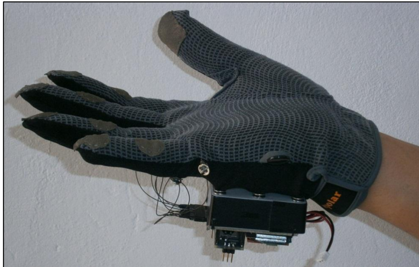
Cap.4: Fig. 28 Conexión sensores de contacto a PCB “Guante Electrónico de Datos”.
