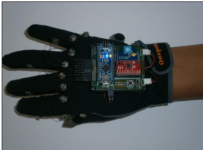
Cap.4: Fig. 26 PCB en “Guante Electrónico de Datos” cara dorsal.
