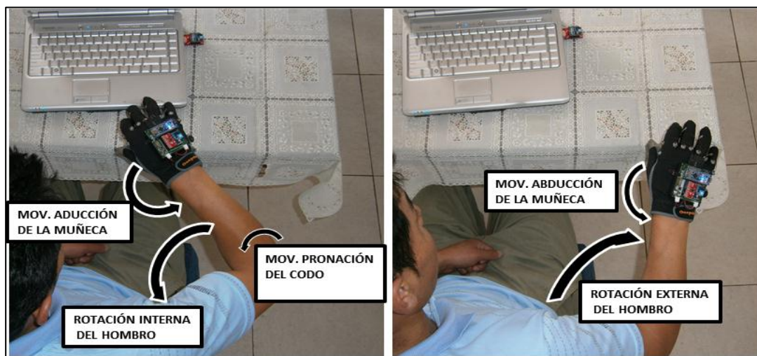
Cap.4: Fig. 36 Movimientos para el desplazamiento horizontal del cursor.
