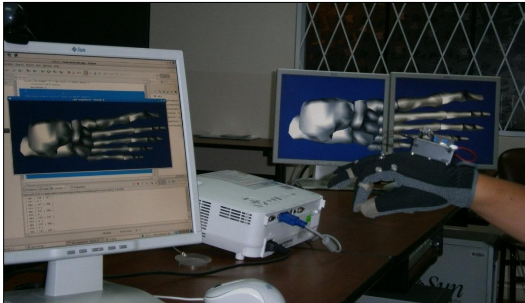
Cap.4: Fig. 40 Prueba de operación con imagen de un pie humano en 3D.
