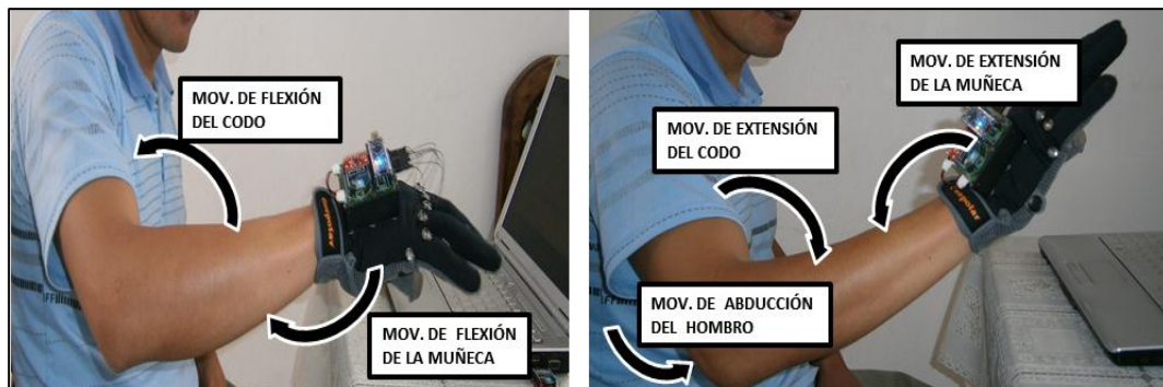
Cap.4: Fig. 37 Movimientos para el desplazamiento vertical del cursor.
