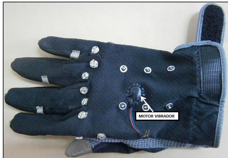
Cap.4: Fig. 16 Montaje motor vibrador.
