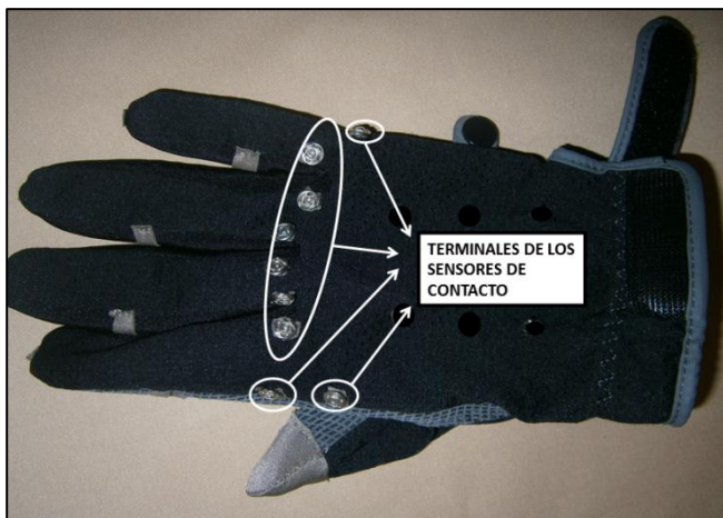
Cap.4: Fig. 13 Terminales de los sensores de contacto.
