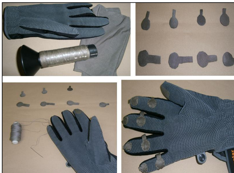
Cap.4: Fig. 11 Montaje de sensores de contacto.
