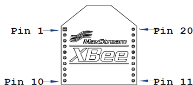
Cap.3: Fig. 4 Designacion pines Módulo XBee.
