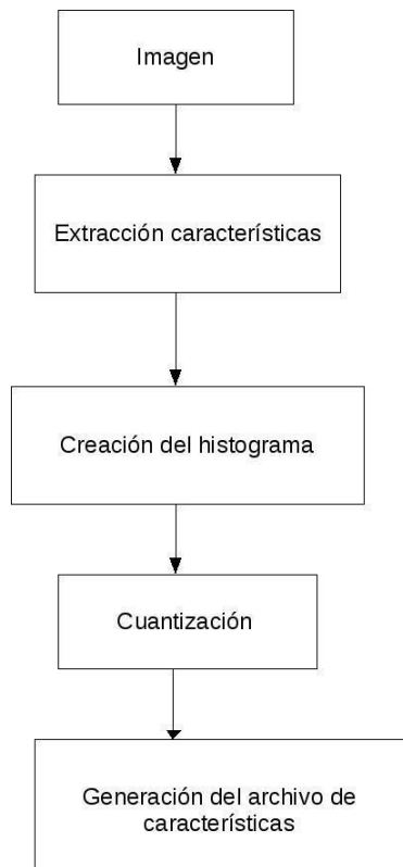
Figura 44: Módulo para procesar el histograma RGB que muestra las distintas etapas para generar el archivo con los datos del histograma RGB.
