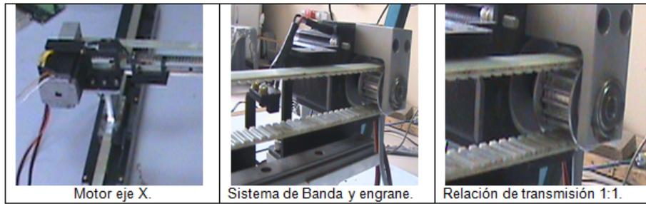
**Figura 5.2:** Sistema de tracción eje X.
