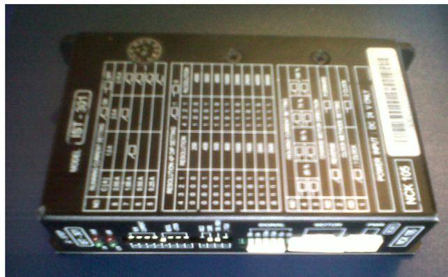
**Figura 2.2:** Driver para Motores a Pasos.
