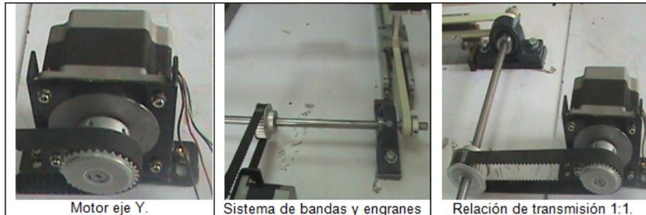
**Figura 5.3:** Sistema de tracción eje Y.
