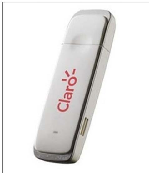
**Fig 1.9.** Módem USB para servicio de Banda Ancha Móvil. Tomado de <http://nuestromercado.clasificados.pe/producto/218326-modem-zte-con-chip-claro-internet-inalambrico>
