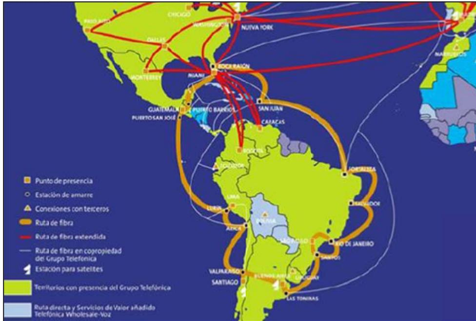
**Fig 2.7.** Gráfico de backbone de Cables Submarinos de Telefónica International Whole Services.
