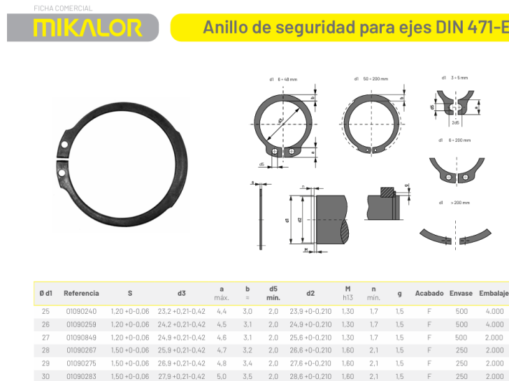
Figura 28. Tabla de anillo de seguridad para ejes DIN 471-E.
