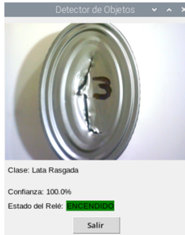
Figura 50: Detección de lata mala - rasgada. Fuente: Autor.
