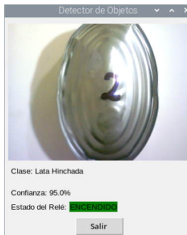
Figura 49: Detección de lata mala - hinchada. Fuente: Autor.
