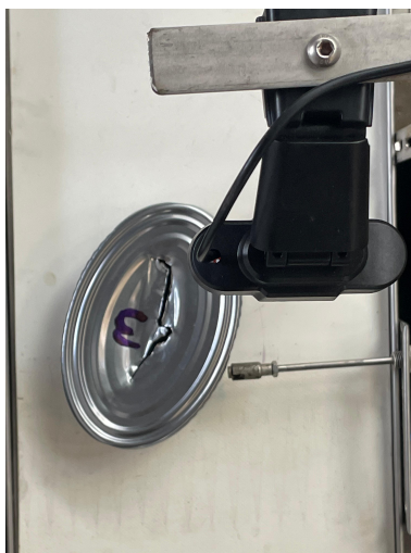
Figura 60: Procesamiento de la imagen de lata rasgada en mal estado. Fuente: Autor.
