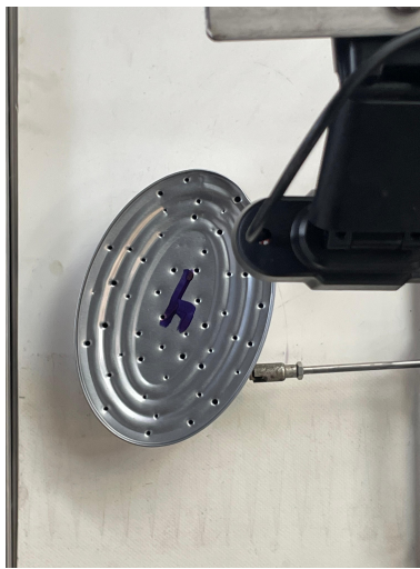
Figura 62: Procesamiento de la imagen de lata perforada en mal estado. Fuente: Autor.
