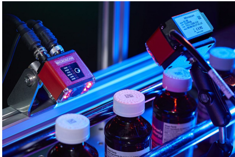
Figura 6: Verificación de códigos con inspección artificial [17].
