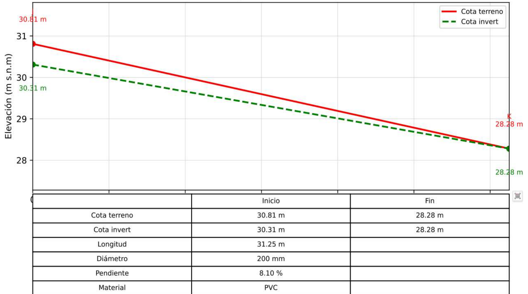
Perfil longitudinal del tramo J-K
