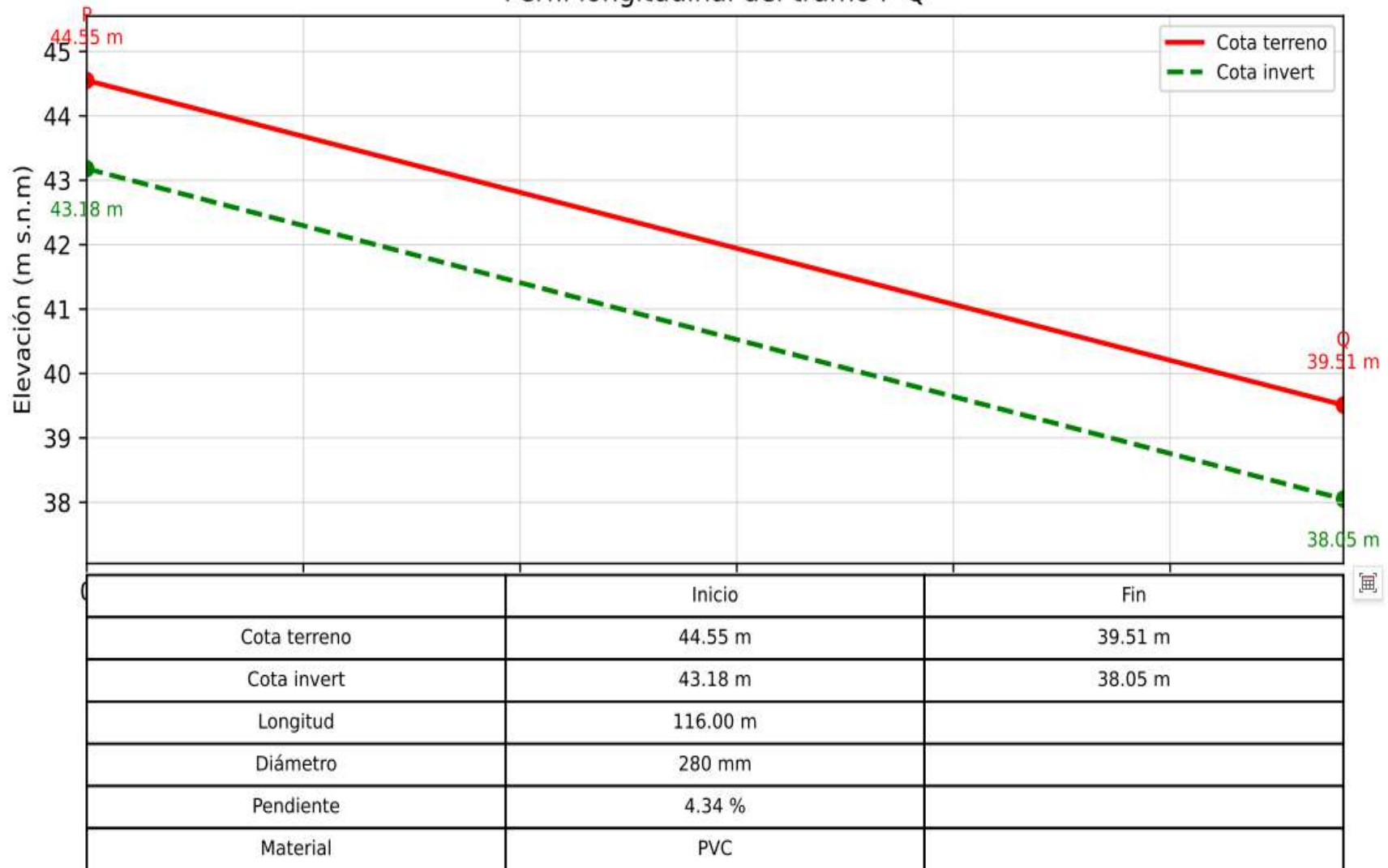
Perfil longitudinal del tramo P-Q
