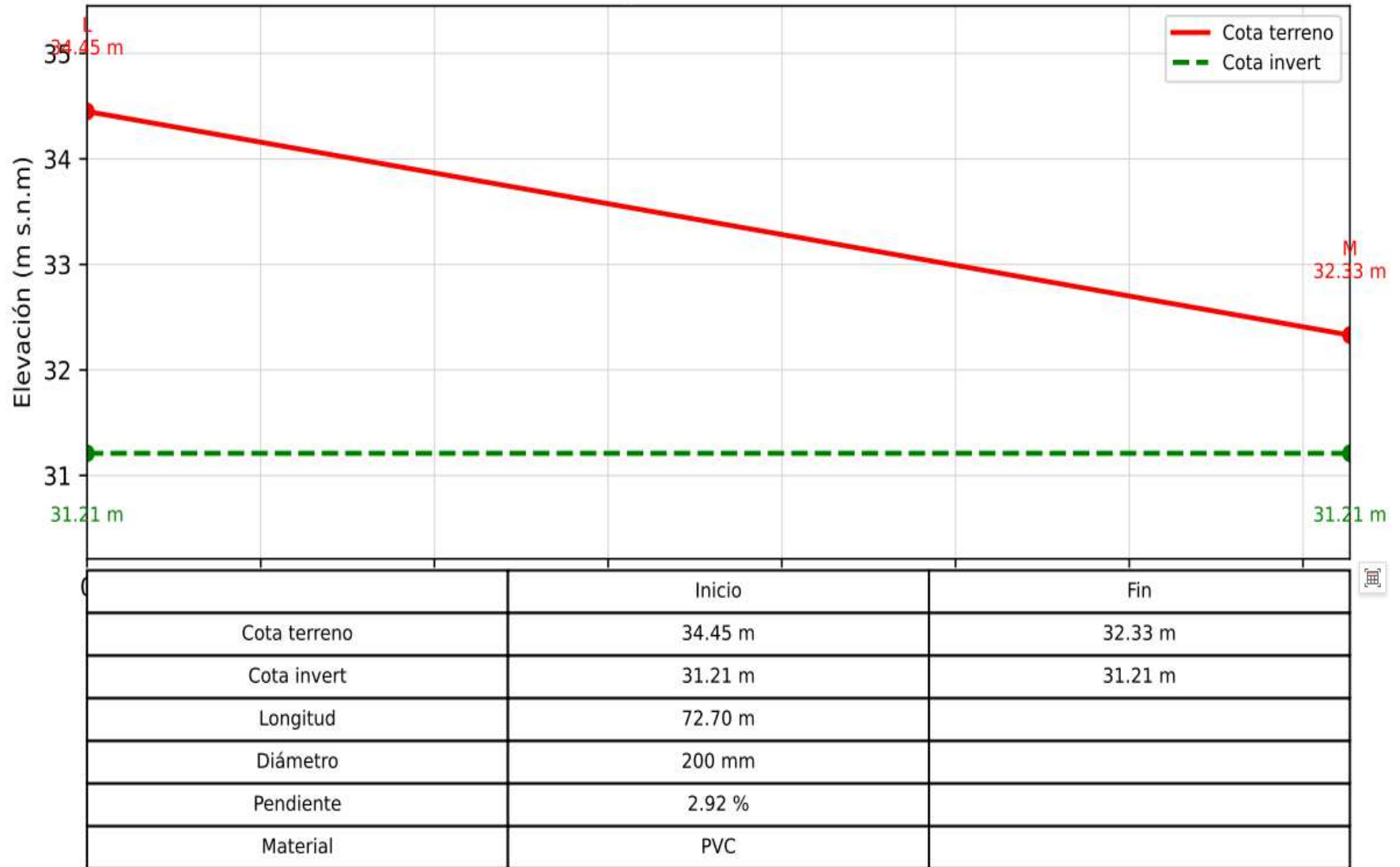
Perfil longitudinal del tramo L-M
