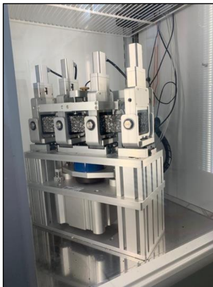
Figura 2. Equipo de resistencia a fatiga en 4 puntos. Fuente: (Nosetti et al., 2020)
