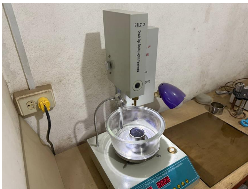
Figura 8. Ensayo de Penetración. Elaboración propia.
