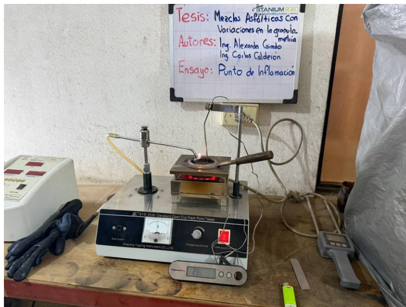
Figura 10. Ensayo de punto de inflamación. Elaboración propia.
