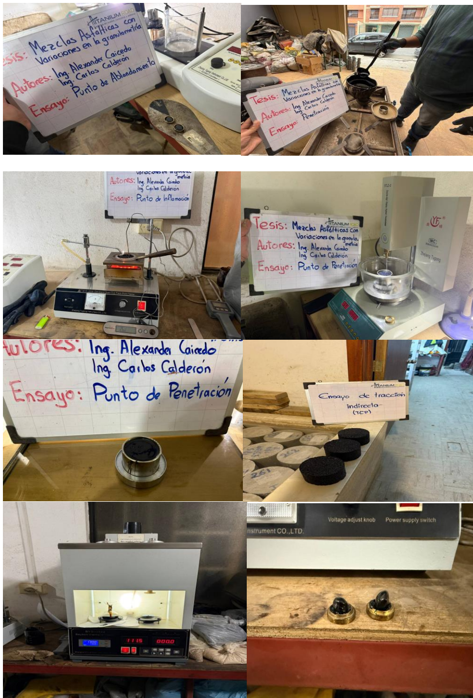
Figura 37. Ensayos de betún asfáltico.
