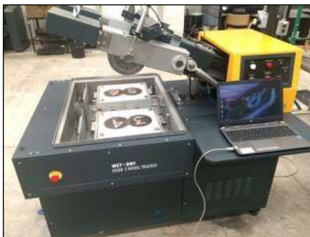
Figura 1. Equipo de rueda de carga – Wheel Tracking. Fuente: (Flores et al., 2018)
