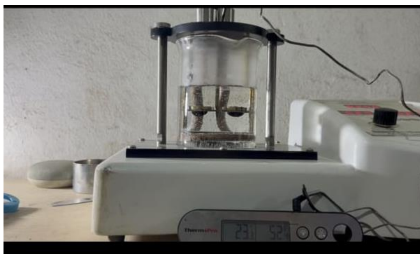
Figura 9. Punto de ablandamiento. Elaboración propia.
