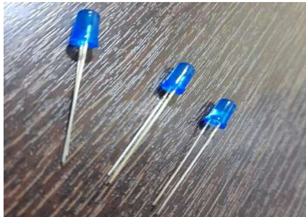
Figura 41. Leds de señalización
