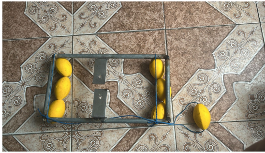
Figura 55. Fabricación de base flotadora de prototipo
