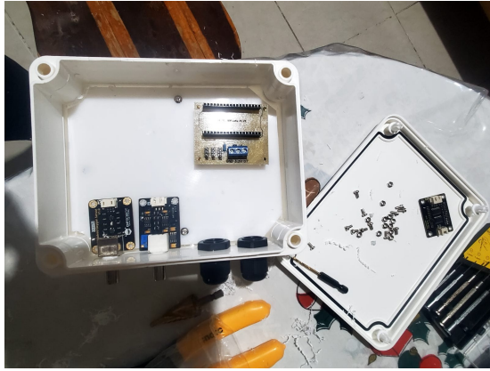
Figura 53. Ensamblaje de módulos y placa pcv de prototipo
