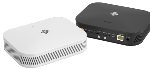
Figura 36. Rak Wisgate lite 2 versión sin LTE
