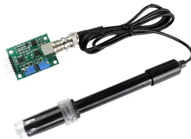
Figura 41. Sensor de PH
