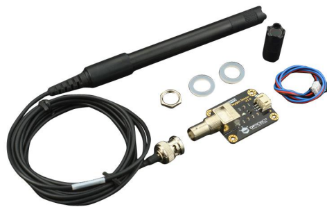
Figura 40. Sensor de oxígeno disuelto, Df Robot.
