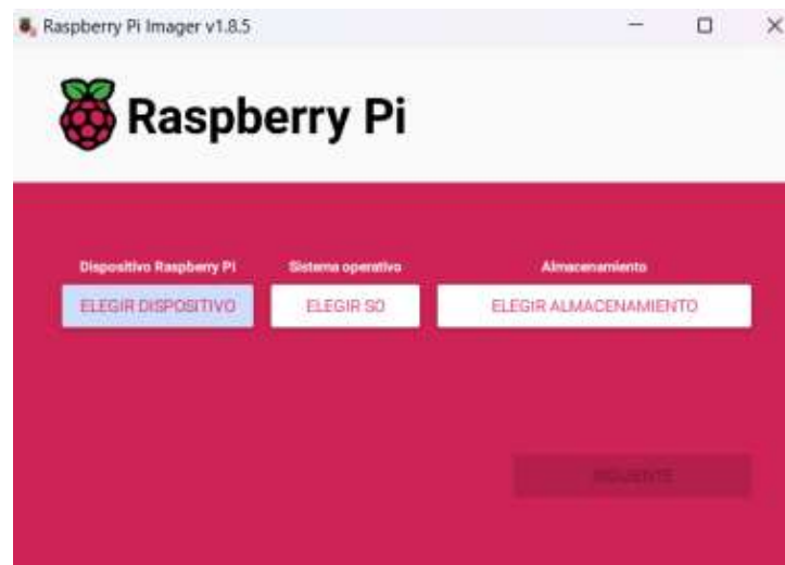
Figura 25 Ventana inicial para escoger el tipo de sistema operativo y su lugar de almacenamiento.
