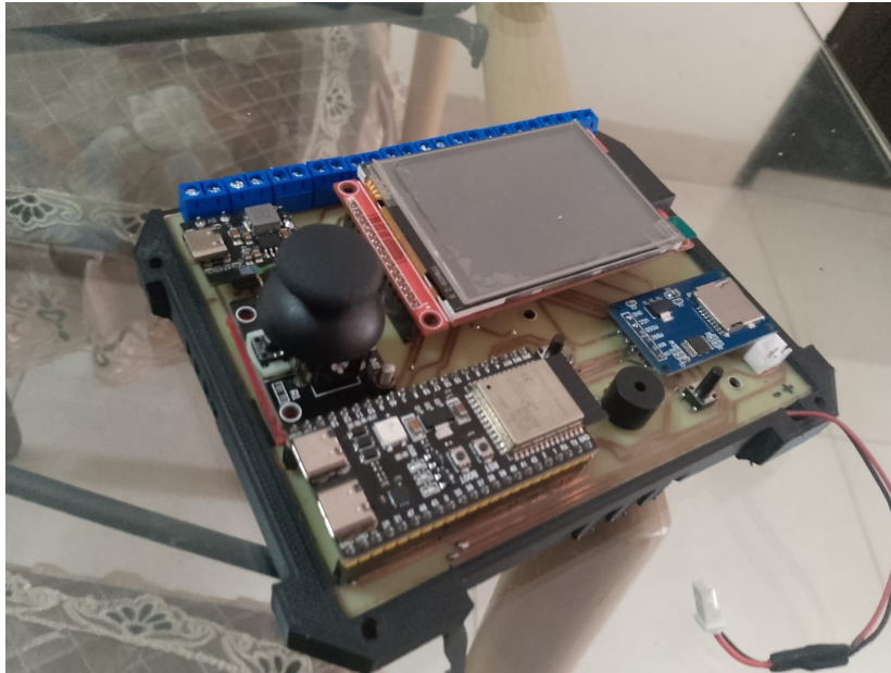
Figura 34. Montaje de la pantalla TFT y controles mecánicos en la cara interna de la carcasa superior.
