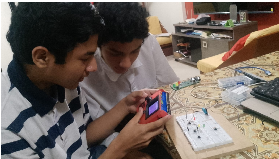
Figura 62. Estudiantes realizando pruebas de interfaz y control con la consola educativa conectada a un circuito en protoboard.
