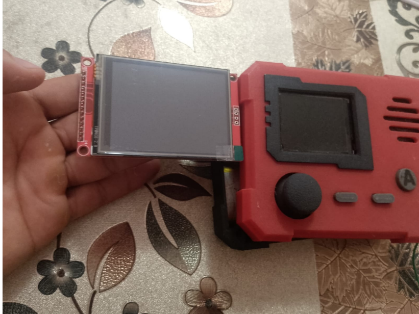
Figura 23. Fallo de validación dimensional en el prototipo V1.
