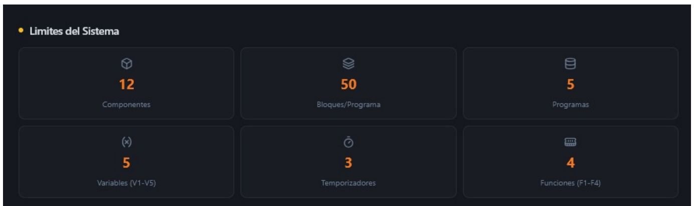
Figura 49. Interfaz web: Límites del sistema (componentes, bloques, programas, variables, temporizadores y funciones).
