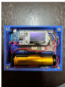
Figura 38. Montaje de los componentes en la carcasa 3D.
