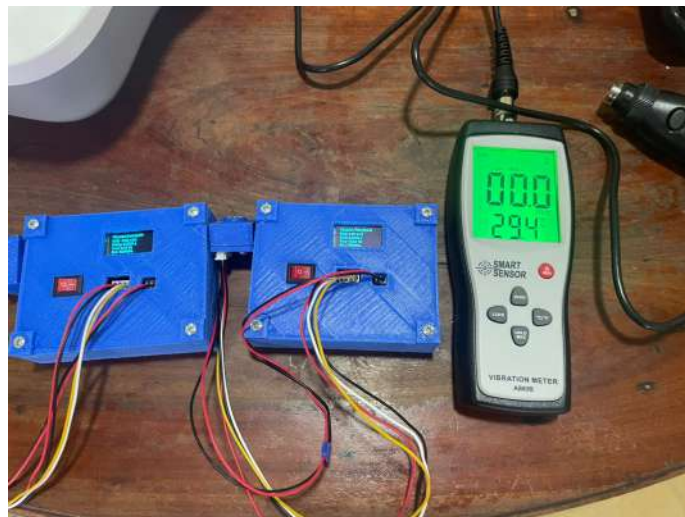
Figura 45. Equipos de medición de vibraciones.
