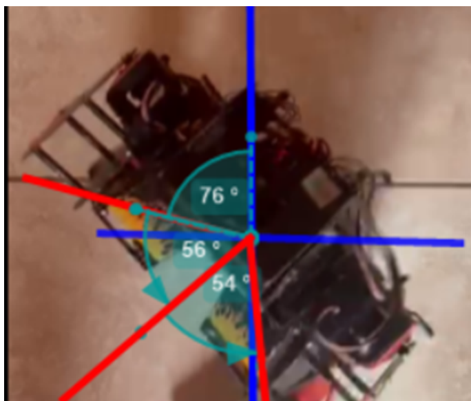
Figura 10. Análisis del movimiento de rotación del robot original mediante el software Kinovea. Elaborado por autores.
