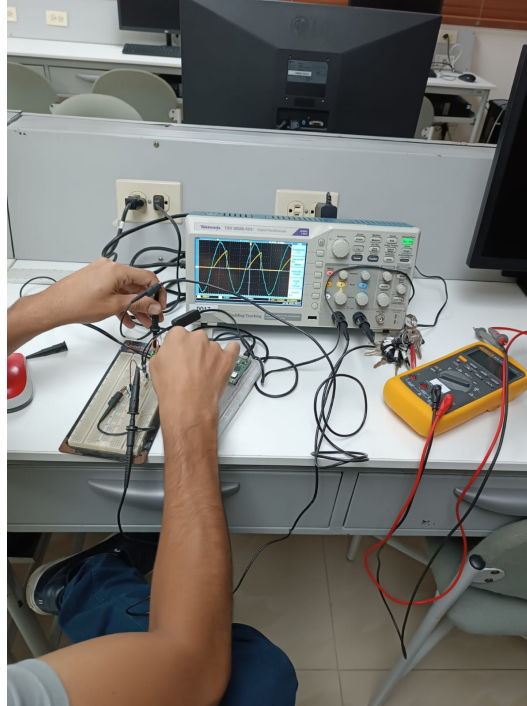
Figura 57. Señal senoidal de entrada AC con señal rectificadora controlada, Elaborado por autores
