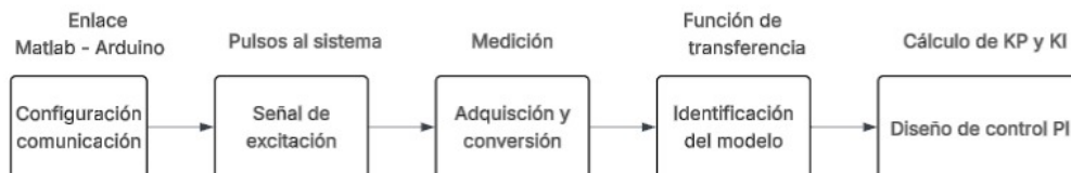
Figura 69. Diagrama de comunicación con MatLab, elaborado por autores
