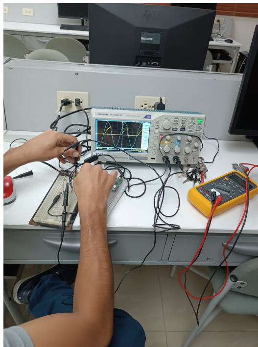
Figura 81. Señal senoidal de entrada AC con señal rectificadora controlada, Elaborado por autores
