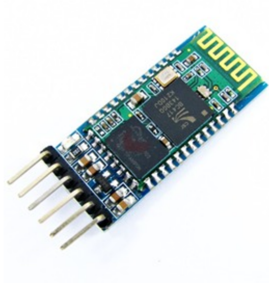
Figura 6. Módulo Bluetooth HC-05 [23]
