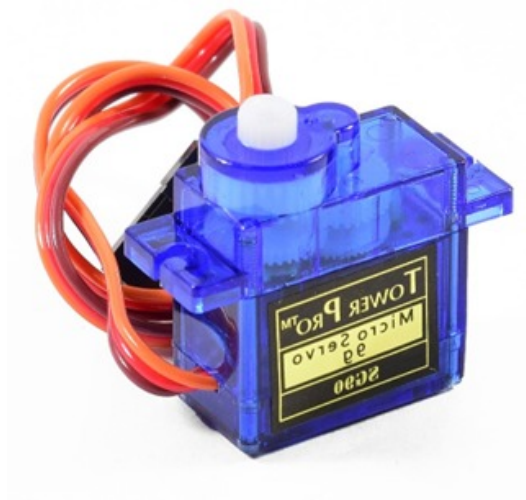
Figura 7. Servomotor actuador electromecánico [25]
