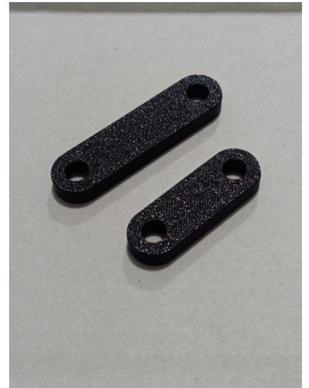
Figura 24. Diseño y modelo final en 3D de enlaces de eslabón. Elaborado por autores
