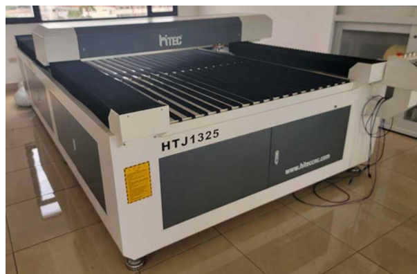
Figura 9. Imagen de HTJ1325 máquina de corte y grabado láser. Fuente: K. Cruz y O. Bolaños.
