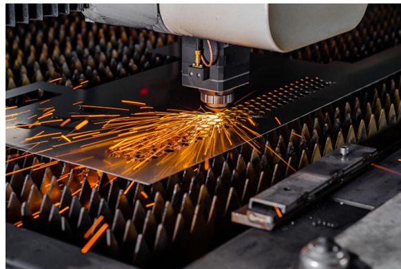
Figura 10. Láser de alta potencia fundiendo y vaporizando material de metal en línea de corte [42].
