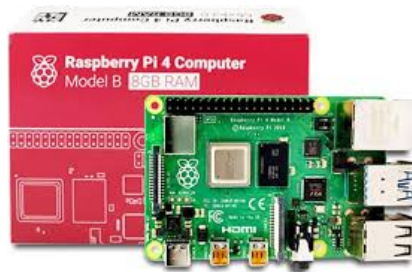
Figura 8. Placa Raspberry Pi 4 Model B, utilizada como unidad de procesamiento principal del sistema. [50]
