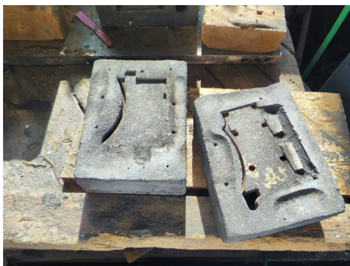
Figura 57. Preparación de moldes para fundición.[81]
