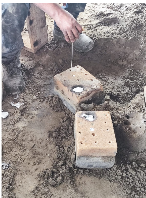
Figura 61. Preparación de moldes para fundición.[81]
