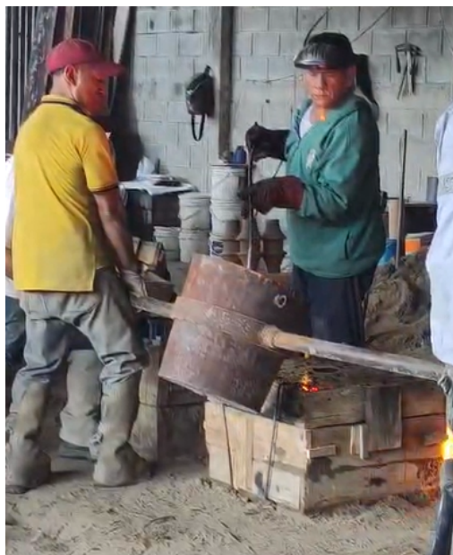
Figura 58. Horno caliente hasta alcanzar temperatura correcta.[81]
