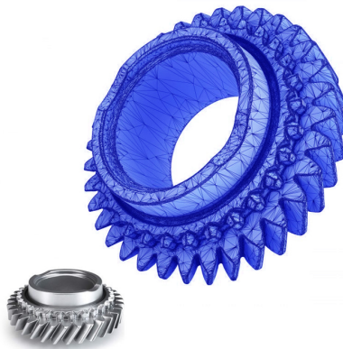
Figura 1. Ejemplo de escaneo 3D industrial, donde se muestra la captura y reconstrucción de piezas mecánicas. [26]
