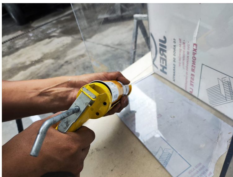
Figura 31. Ensamblaje de láminas de acrílo con silicón. [81]
