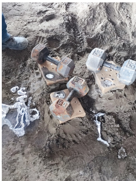
Figura 60. Colocación de peso sobre moldes y piezas fundidas.[81]
