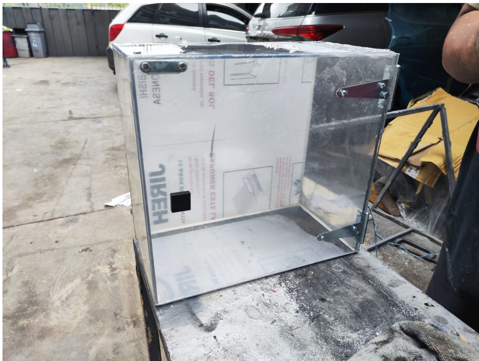
Figura 33. Instalación de puerta abatible.[81]
