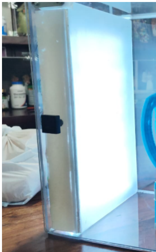
Figura 36. Ubicación del sistema de iluminación y difusor dentro de la caja de acrílico.[81]
