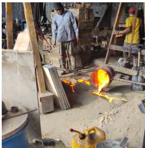
Figura 59. Vertido de aluminio dentro de moldes.[81]
