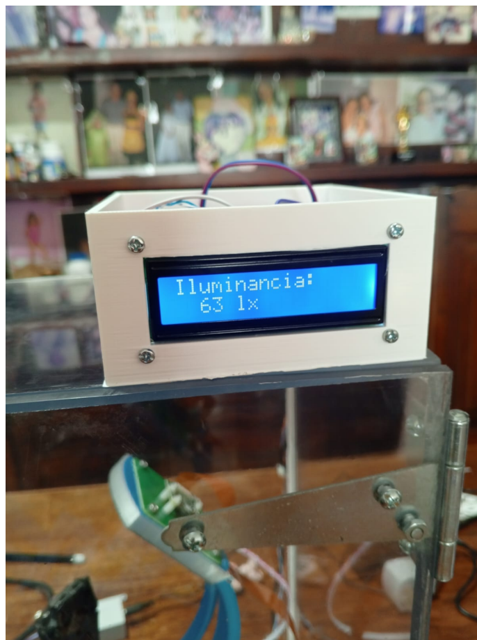
Figura 39. LCD muestra valores de Iluminancia.[81]
