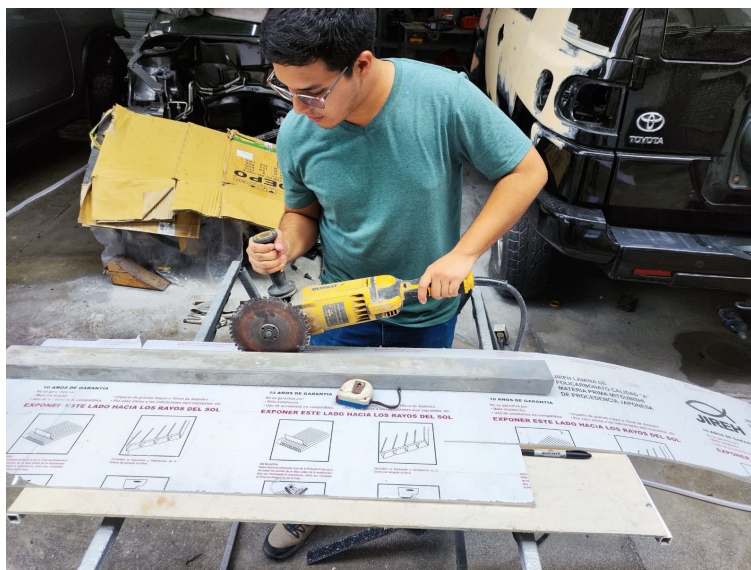
Figura 30. Realización de los cortes para armado de caja.[81]
