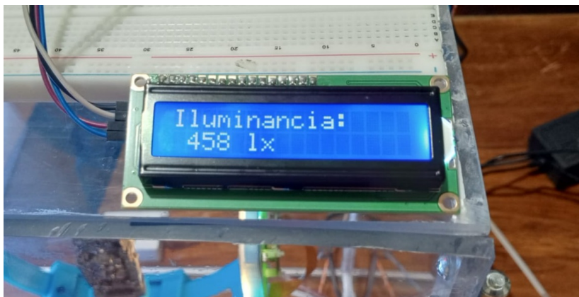
Figura 85. LCD muestra luminancia sensada.[81]
