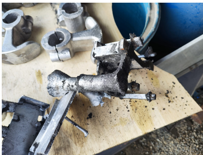
Figura 63. Extracción de piezas fundidas.[81]
