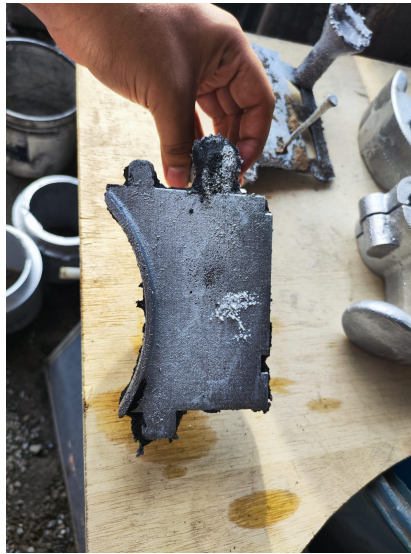
Figura 64. Eliminación de excesos de material.[81]
