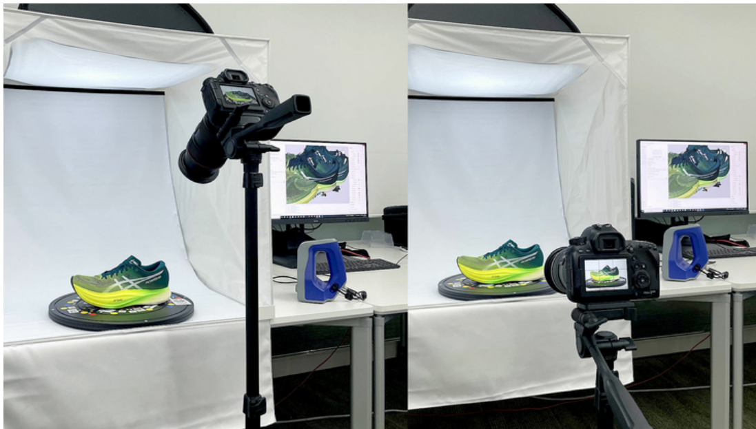
Figura 6. Escaneo por fotogrametría donde se aplica iluminancia controlada. [46]
