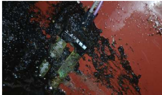
Figura 57. Sensor de humedad del suelo instalado en el sustrato para el monitoreo del riego automático. Fuente: Los autores.
