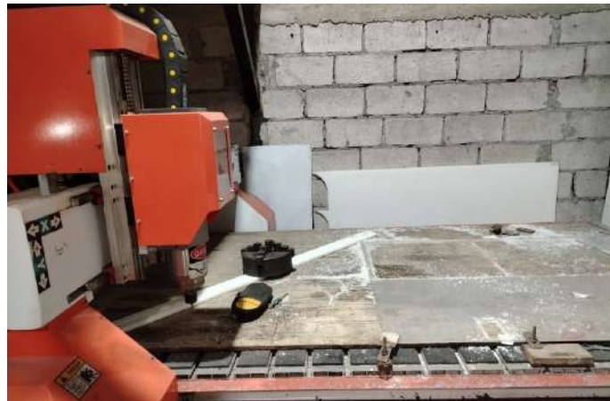
Figura 51. Corte de paneles mediante máquina CNC para la fabricación del prototipo de incubadora. Fuente: Los autores.
