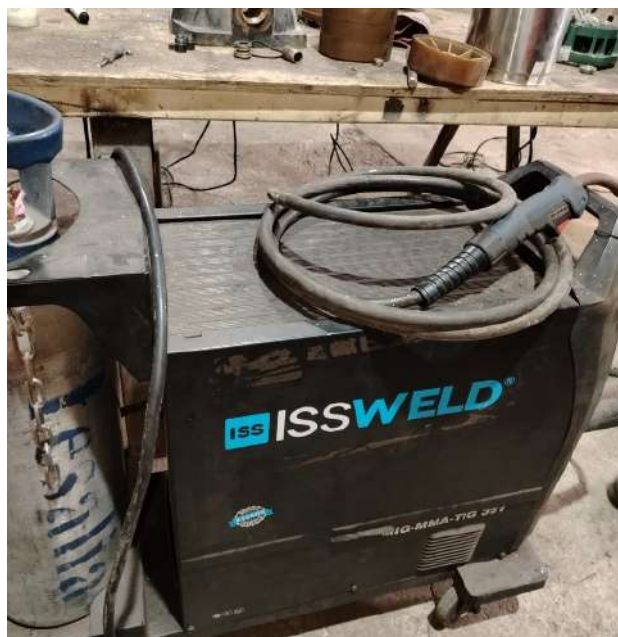
Figura 52. Equipo de soldadura utilizado en la fabricación de la estructura metálica del prototipo. Fuente: Los autores.
