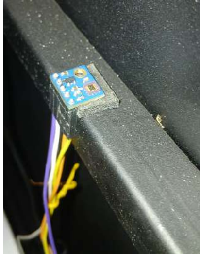
Figura 56. Sensor digital de intensidad luminosa instalado en la estructura de la incubadora. Fuente: Los autores.
