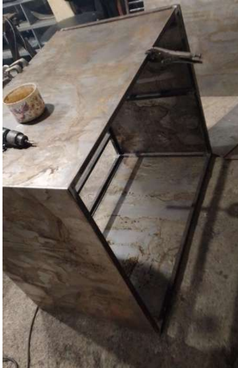
Figura 50. Estructura metálica del prototipo de incubadora en proceso de fabricación. Fuente: Los autores.
