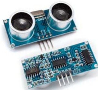
Figura 5. Sensor ultrasónico HC-SR04.
