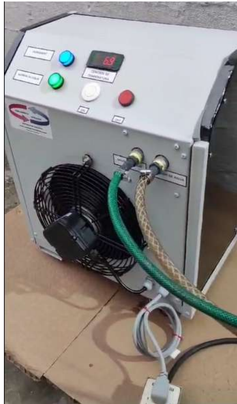
Figura 7: Chiller ensamblado [Fuente: Los Autores].
