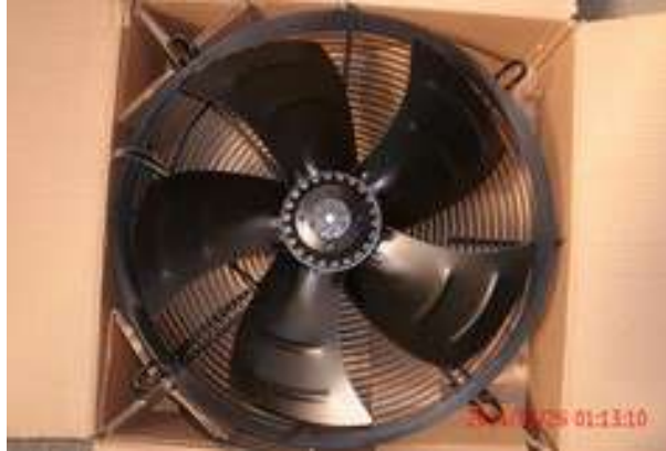
Figura 4: Ventilador y unidad condensadora MAER [Fuente : Los Autores].
