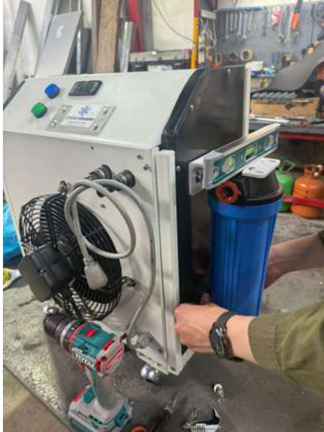
Figura 17: Nivelación y fijación del filtro al chasis [Fuente: Los Autores].
