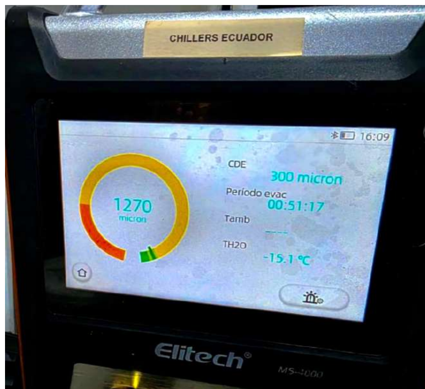
Figura 16: Certificación de vacío profundo (300 micrones) en el display del Elitech MS-4000 [Fuente: Los Autores].
