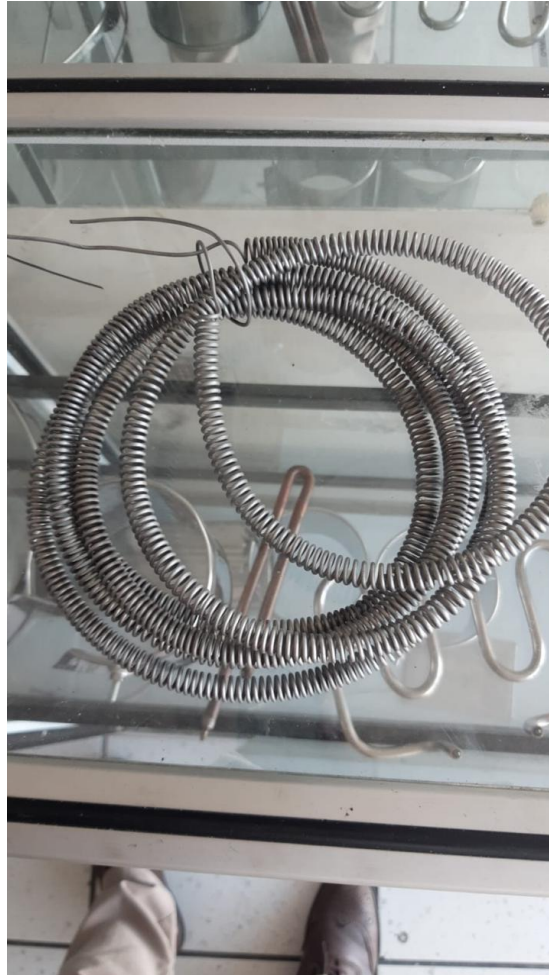
Figura 21. Resistencia de Nicrom (NiCr) enrollada en espiral. Por Autores
