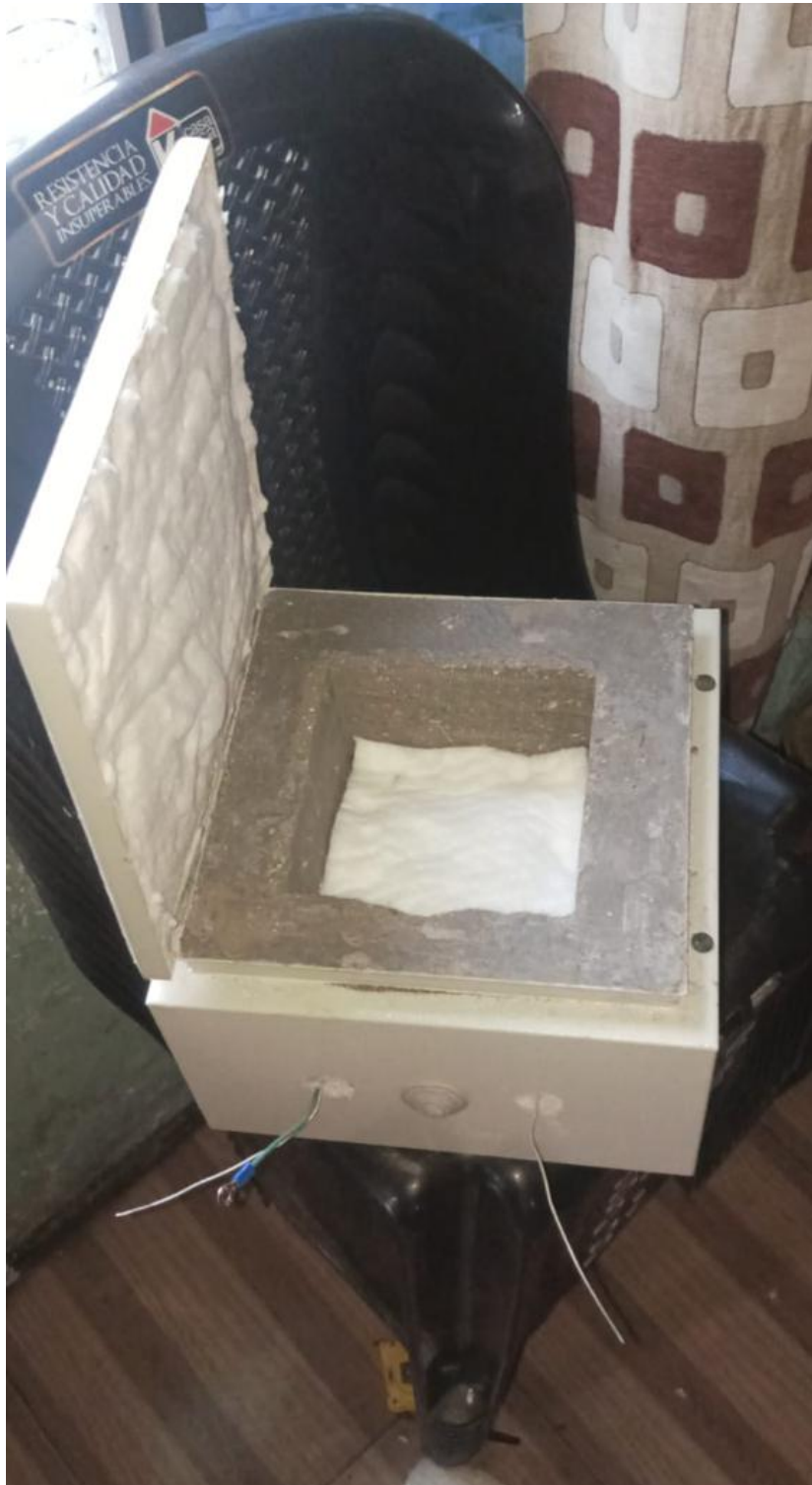
Figura 43. Recubrimiento interno con fibra cerámica para aislamiento térmico. Por Autores
