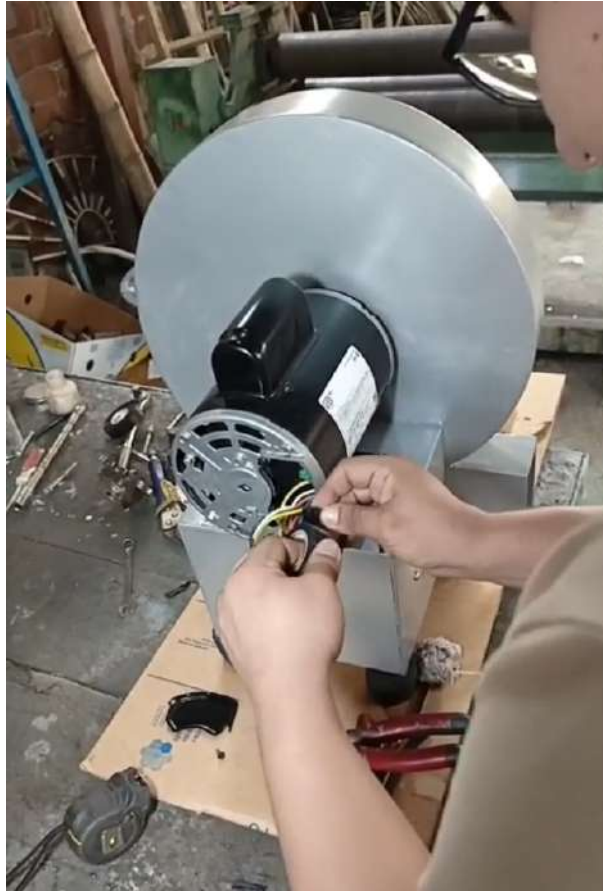
Figura 16. Instalación del motor y configuración de giro antihorario.
