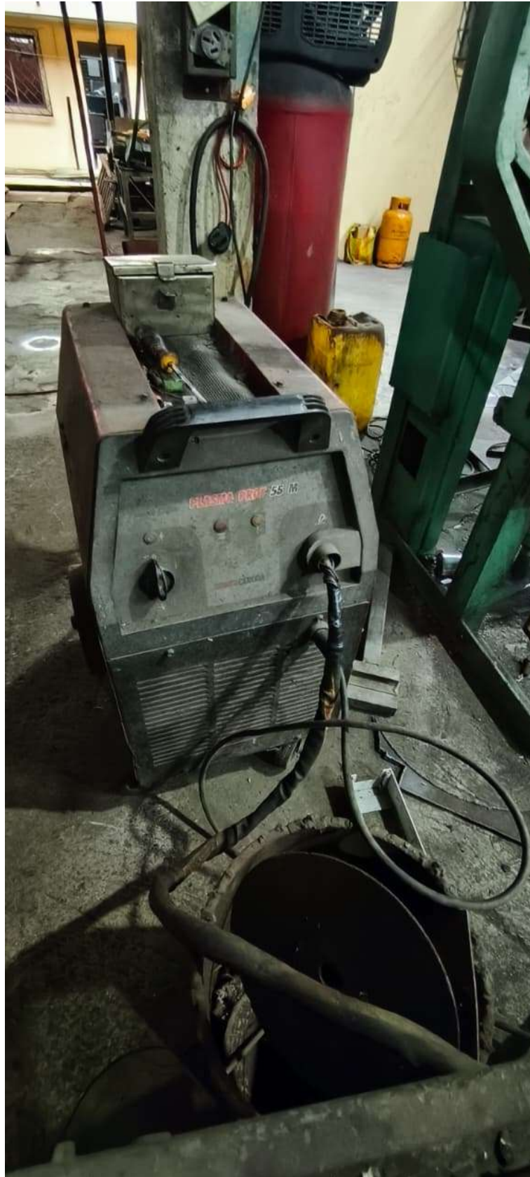
Figura 38. Cortadora de plasma la cual se usó para realizar todos los cortes de las planchas, por J. Bayas
