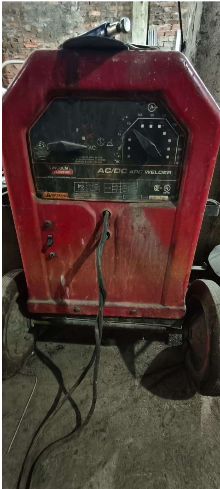
Figura 36. Soldadora la cual se usó para realizar las uniones de las estructuras, por J. Bayas
