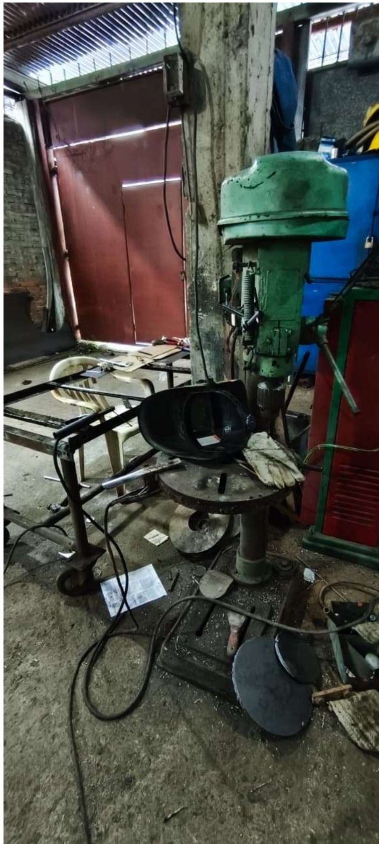
Figura 39. Taladro de pedestal el cual se usó para realizar todos los agujeros para la sujeciones, por J. Bayas
