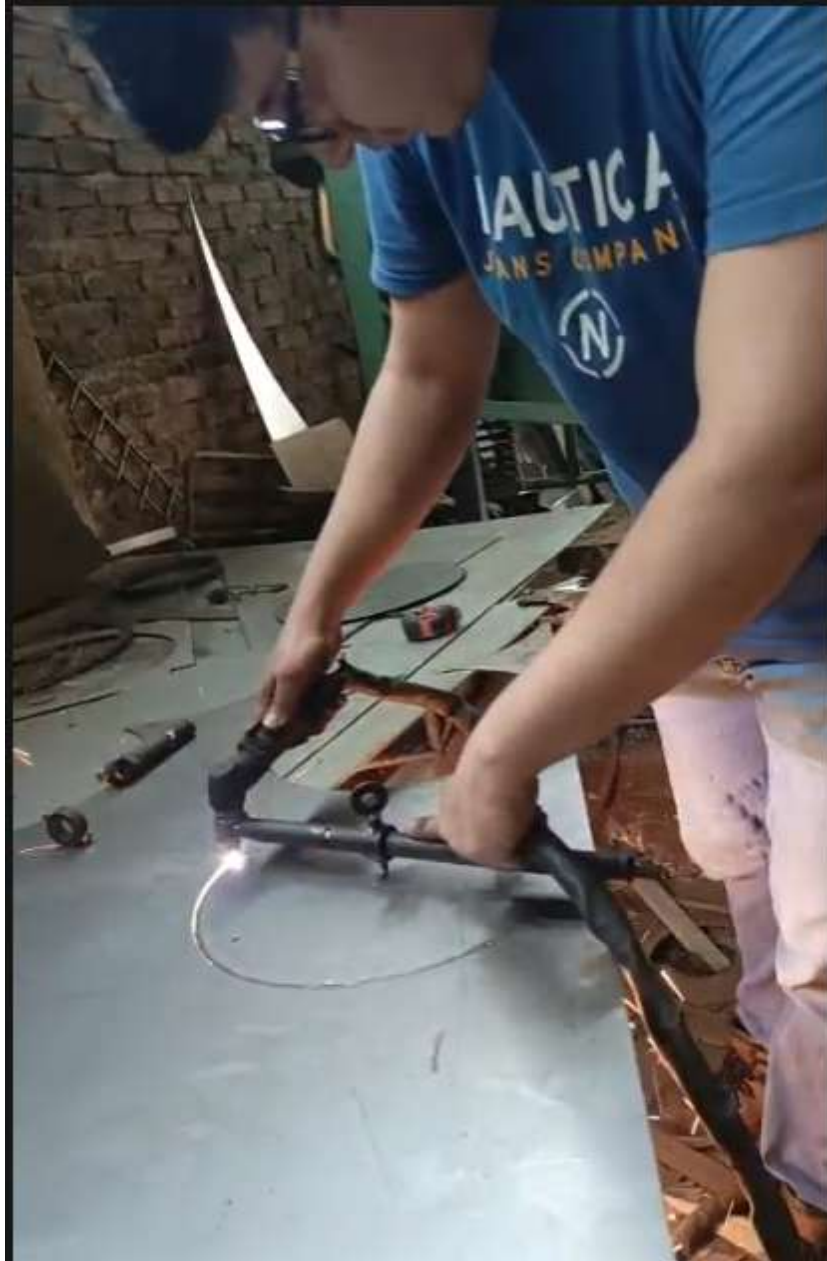
Figura 5. Ejecución del corte por plasma minimizando el aporte térmico.
