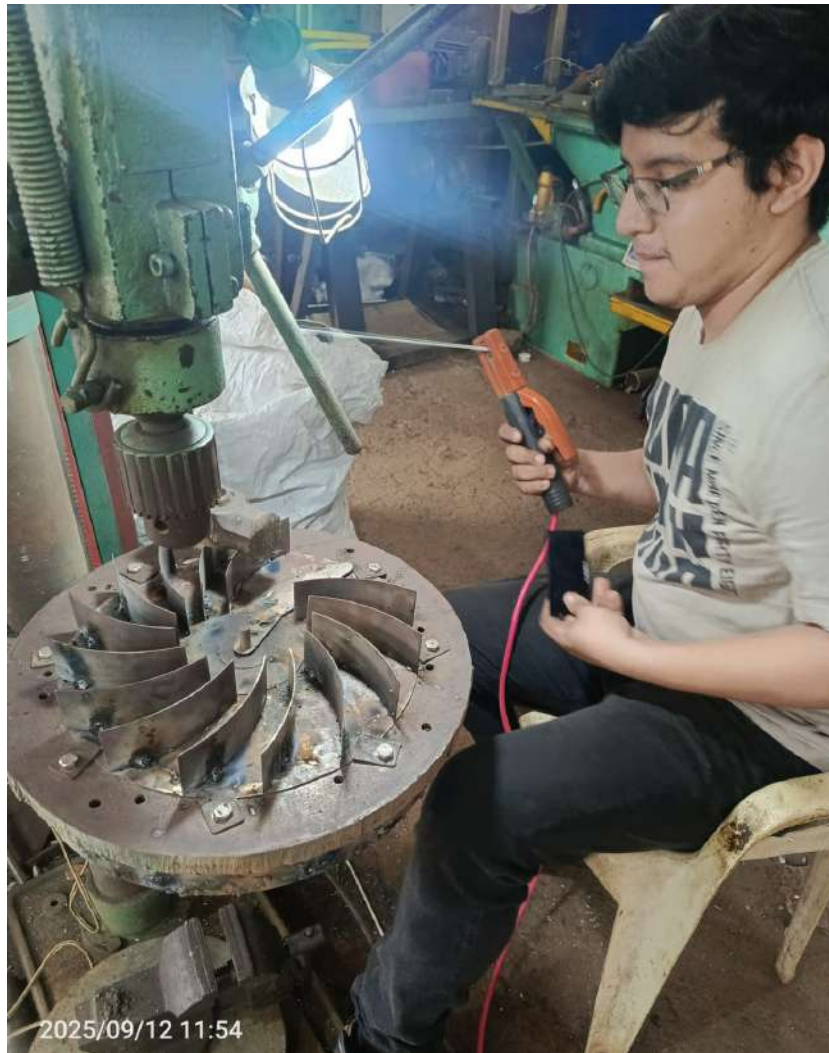
Figura 7. Soldadura de precisión de los álabes del rodete centrífugo.
