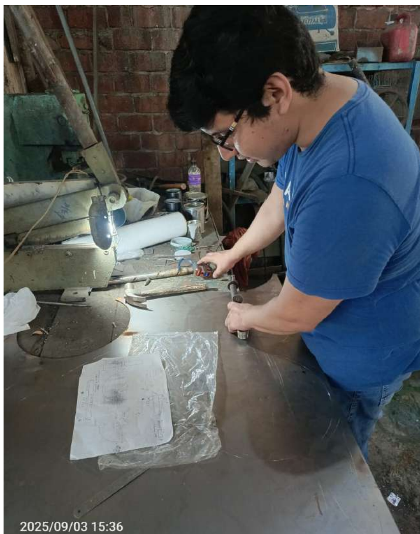
Figura 4. Trazado de patrones de corte sobre lámina metálica.
