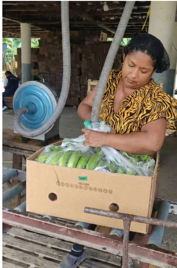
Figura 23. Operario realizando el proceso de vacío con el sistema industrial desarrollado.
