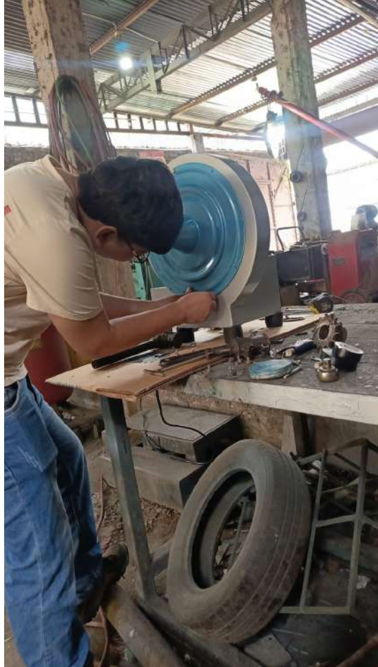
Figura 14. Cierre hermético de la voluta mediante pernería de alta densidad.
