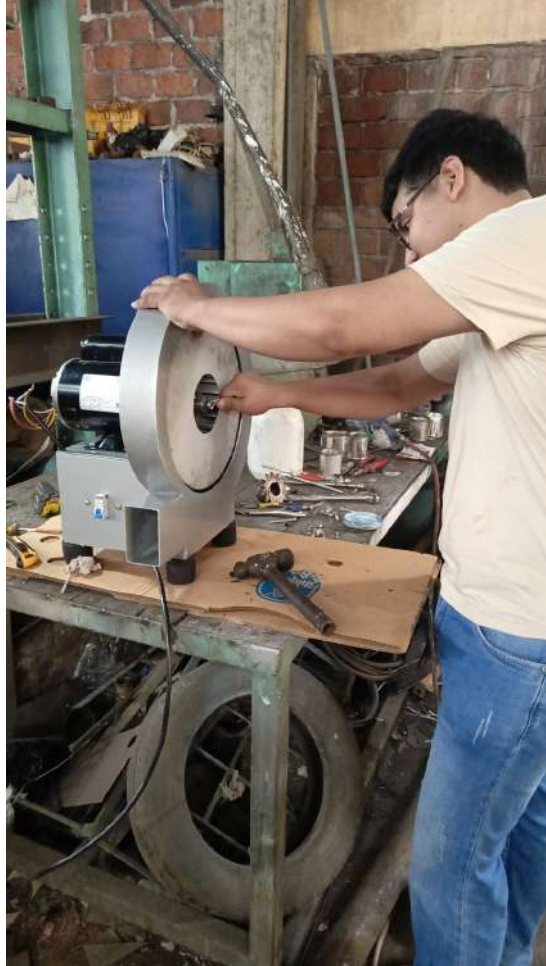
Figura 13. Acople mecánico del rodete al eje del motor.
