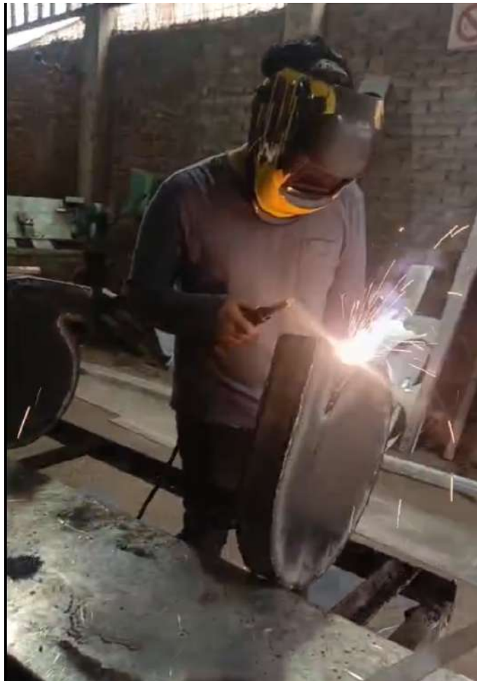
Figura 6. Proceso de soldadura de la voluta asegurando hermeticidad.
