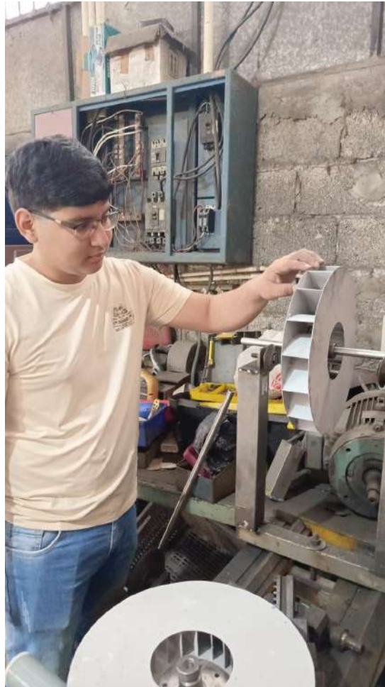
Figura 8. Proceso de balanceo dinámico del conjunto rotativo.
