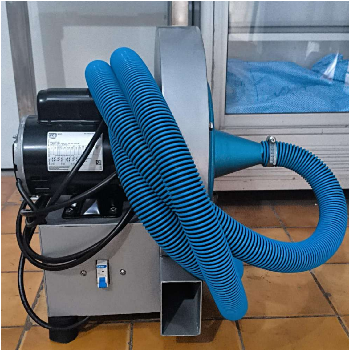
Figura 17. Prototipo final del sistema de aspiración industrial ensamblado.
