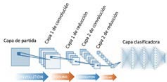
Figura 19: Arquitectura de una Red Neuronal Convolucional (CNN).
