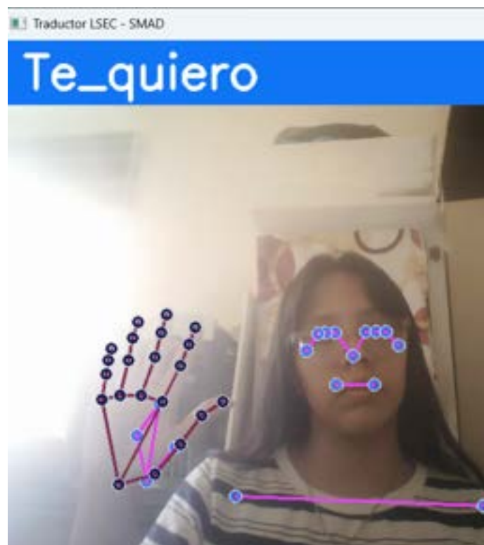
Figura 77: Fallo de clasificación por iluminación deficiente.
