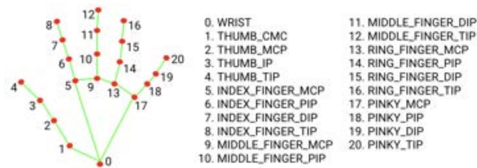
Figura 27: Topología del modelo de mano en MediaPipe.
