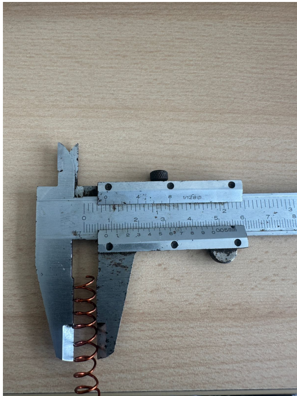
Figura 28. Medición de resorte fabricado
