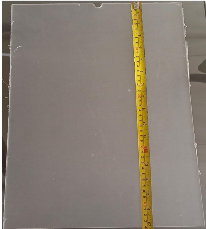
Figura 41. Medida de largo de la plataforma que recibirá el peso del paciente. Fuente: Autoría Propia.
