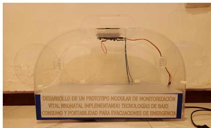
Figura 40. Vista frontal de la carcasa construida. Fuente: Autoría Propia.
